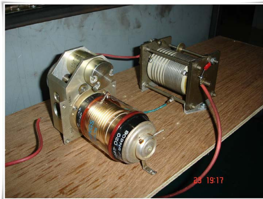
ภาพประกอบ ข.3 ตัวเก็บประจุและตัวเหนี่ยวนำแบบปรับค่าได้สำหรับการแมชอินพีแดนซ์
