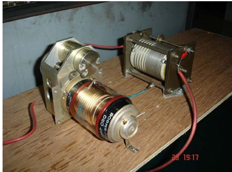
ภาพประกอบที่ 3.5 ตัวเก็บประจุและตัวเหนี่ยวนำแบบปรับค่าได้ใช้ในการแมตช์อิมพีแดนซ์
