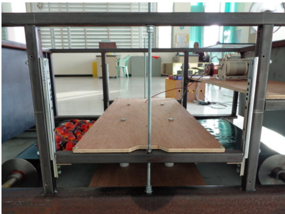
ภาพประกอบ ข.4 ตัวปล่อยสนามไฟฟ้าสามารถปรับระยะห่างได้
