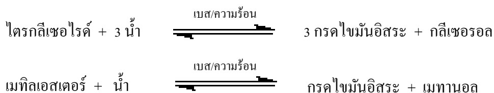
ภาพประกอบที่ 2.4 ปฏิกิริยาไฮโดรไลซิสของไตรกลีเซอไรด์และเมทิลเอสเทอร์ในกระบวนการผลิตไบโอดีเซล
