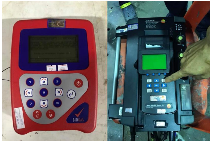
a) เครื่องวิเคราะห์สภาพก๊าซชีวภาพ b) เครื่องวัดก๊าซจากปล่องระบาย Testo 350-XL
