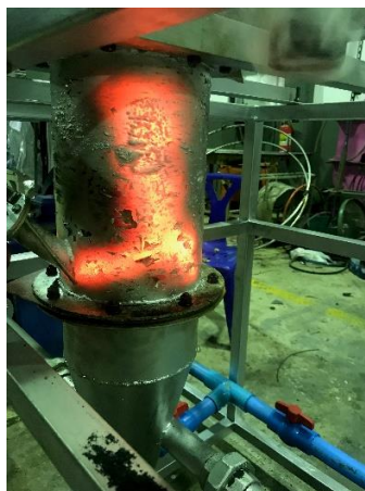
รูปที่ ง.4 ลักษณะปัญหาที่เกิดขึ้นที่เตาฟลูอิดซ์เบต แก๊สซีไฟเออร์
