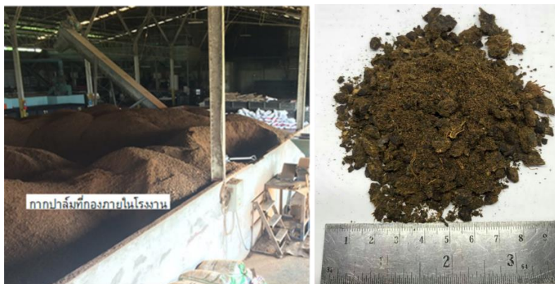
รูปที่ 2 กากปาล์มเป็นส่วนที่เหลือจากโรงงานสกัดน้ำมันปาล์ม
