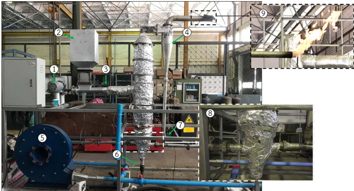
(1) มอเตอร์, (2) ช่องใส่ชีวมวล, (3) ชุดสกรูล้ำเสียง, (4) ไซโคลน, (5) โบลเวอร์, (6) วาล์วสำหรับเก็บ/ระบายชี๊ถั่ว, (7) วาล์วสำหรับเก็บ/ระบายฝุ่นและน้ำมันดิน, (8) ประยุกต์มาจากการคำนวณเชิงตัวเลข, (9) เปลวไฟ รูปที่ 8 เตาฟลูอิดไอดีเบดแก๊สซิไฟเออร์ [9]
