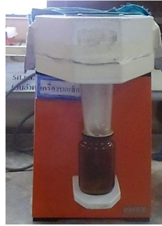
ภาพที่ 2 เครื่องบดขนาดเล็กสำหรับเตรียม กระเทียมผง
