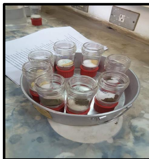
ภาพที่ 8 ครุชบีลแก้วพร้อมตัวอย่างวัตถุคับ
