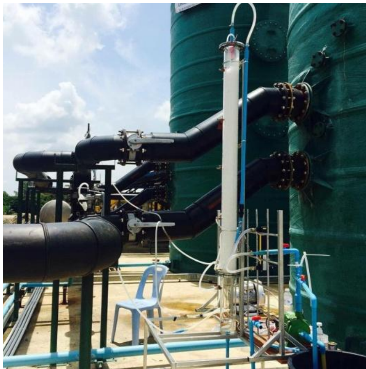
รูปที่ 4.11 ระบบกระบวนการดูดซึมสำหรับทำความสะอาดแก๊สชีวภาพ ณ บริษัท ปาล์มพัฒนา ไบโอดีแก๊สจำกัด
