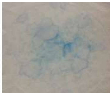
ภาพที่ 34 ผลบวกของปฏิกิริยาการทดสอบคราบน้ำตาลเบื้องต้นด้วยชุดทดสอบ Phadebas paper
