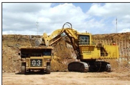
รูปที่ 1.2 รถขุด DEMAG H255S (ขนาดบั้งกี้ 16 ลบ.ม.) และรถบรรทุกขนาดบรรทุก 100 ตัน
