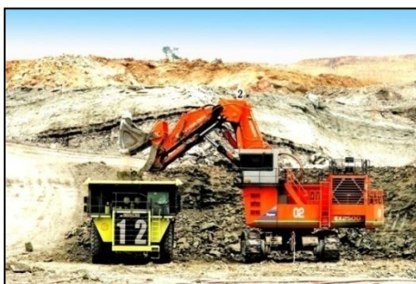
รูปที่ 1.1 รถขุด HITACHI EX 2500e (ขนาดบั้งกี้ 16 ลบ.ม.) และรถบรรทุกขนาดบรรทุก 100 ตัน
