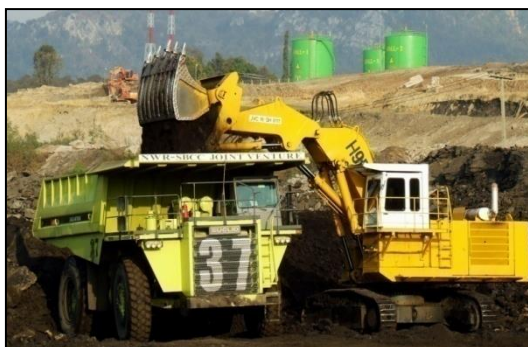
รูปที่ 1.4 รถขุด DEMAG H952500e (ขนาดบั้งกี้ 7.5 ลบ.ม.) และรถบรรทุกขนาดบรรทุก 100 ตัน
