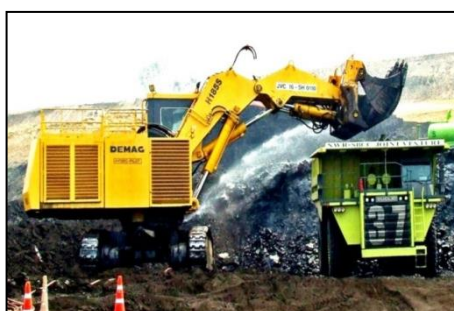
รูปที่ 1.3 รถขุด DEMAG H185S (ขนาดบั้งกี้ 14 ลบ.ม.) และรถบรรทุกขนาดบรรทุก 100 ตัน
