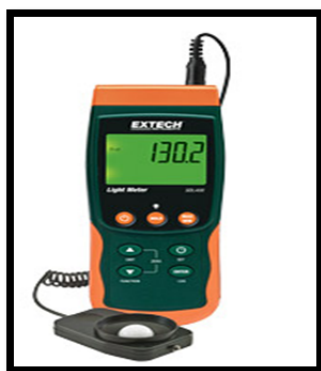
รูปที่ 3-6 เครื่องลักซ์มิเตอร์ (Lux Meter) รุ่น Extech SDL400
