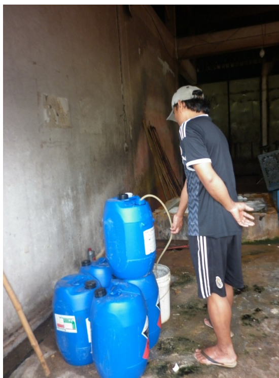
ภาพที่ 4.32 การเตรียมกรดฟอร์มิกเพื่อใช้ในกระบวนการผลิตยางแผ่นดิบของสหกรณ์กองทุนสวนยางบ้านคลองเขาล้อ
