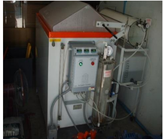
รูปที่ 5 เครื่องทดสอบการกัดกร่อนแบบหมอกเกลือ
