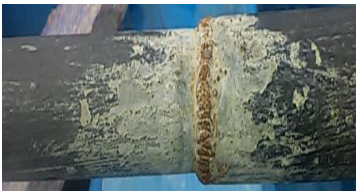
รูปที่ 7 การกัดกร่อนของเพลลาบริเวณรอยเชื่อม
