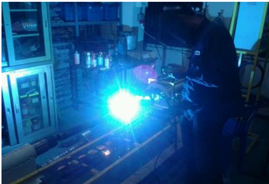
รูปที่ 15 การเชื่อมพอกผิวเพลลาใบจักรชิ้นงานจริง
