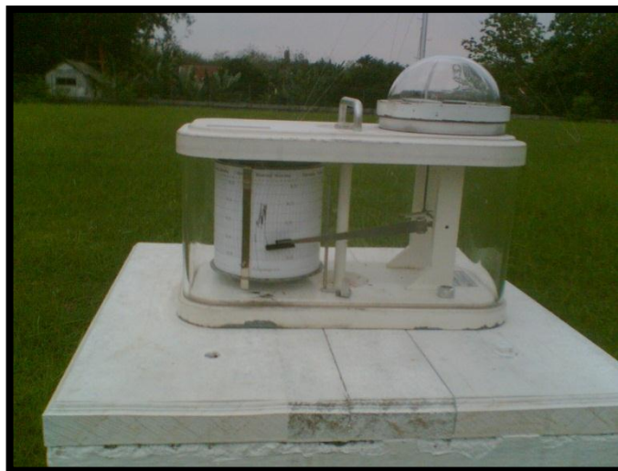
รูปที่ 1.10 ภาพแสดงเครื่องวัดรังสีรวมแบบโรบิตซ์ (Robitzsch pyranometer) ([online], accessed October 17, 2014, available from http://him-dyrk-peters.de/Radiation_recorder.htm )
