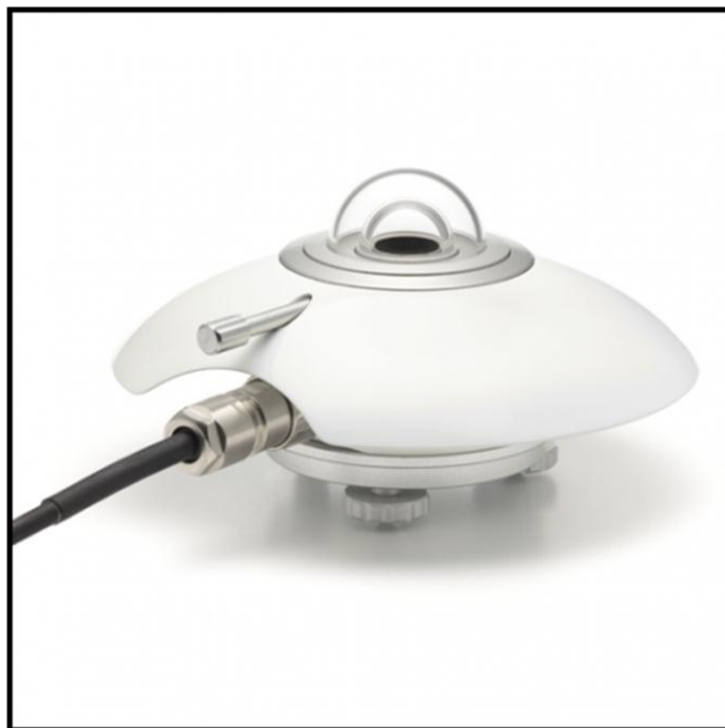
รูปที่ 1.12 ภาพแสดงเครื่องวัดรังสรวมแบบเทอร์โมไพล์ (Thermopile pyranometer) ([online], accessed October 17, 2014, available from http://scottech.net/products/by_supplier/kipp_zonen/pyranometer.htm )
