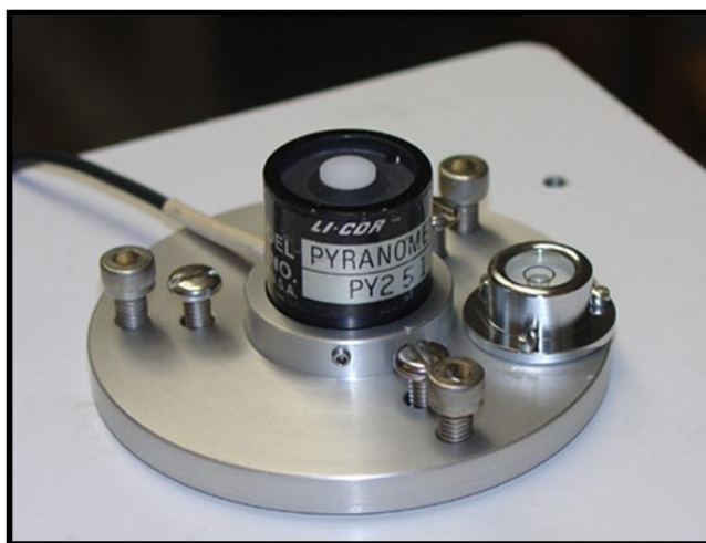
รูปที่ 1.11 ภาพแสดงเครื่องวัดรังสีรวมแบบโฟโตโวลตาอิก (Photovoltaic pyranometer) ([online], accessed October 17, 2014, available from http:// geoscientific.com/datasensors/240_sil_pyran_sensor.htm )
