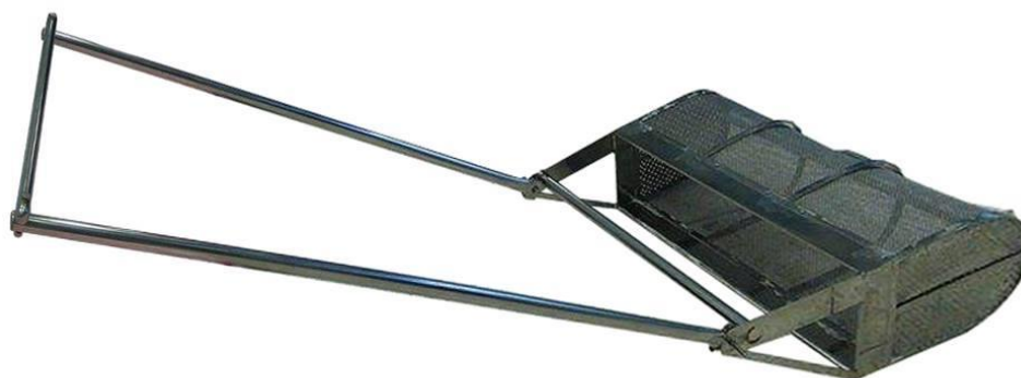
รูปที่ 21 เครื่องมือเก็บตัวอย่างจักจั่นทะเล ดัดแปลงจาก Barnes and Wenner (1968)
