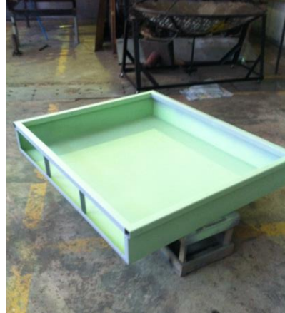
รูปที่ ค-15 ถอดแยกชิ้นงานพ่นสีรองพื้นใหม่อีกรอบ
