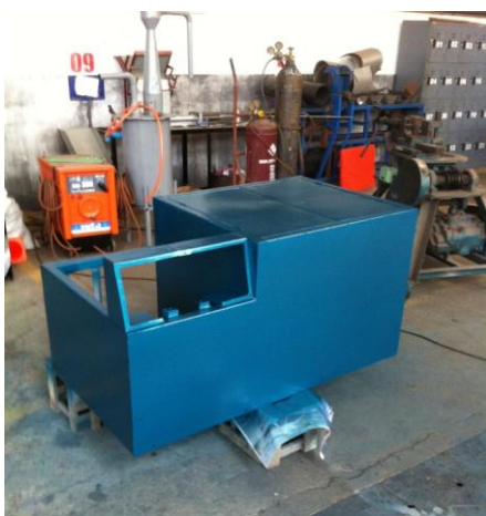
รูปที่ ค-15 ถอดแยกชิ้นงานพ่นสีรองพื้นใหม่อีกรอบ
