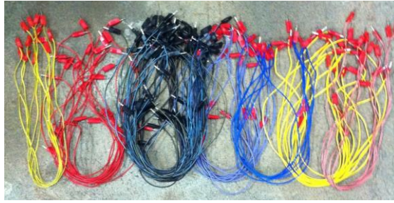
ภาพที่ ค-18 สร้างหัวเสียบสายไฟสำหรับฝึกต่อวงจรต่างๆ
