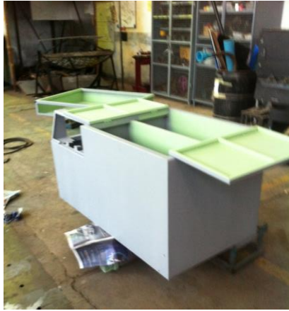
รูปที่ ค-15 ถอดแยกชิ้นงานพ่นสีรองพื้นใหม่อีกรอบ
