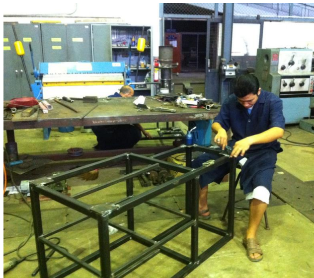
ภาพที่ ค-1 ตัดเหล็กสำหรับสร้างตู้เก็บอุปกรณ์และแผงยึดอุปกรณ์ระบบไฟแสงสว่างและไฟสัญญาณรถยนต์
