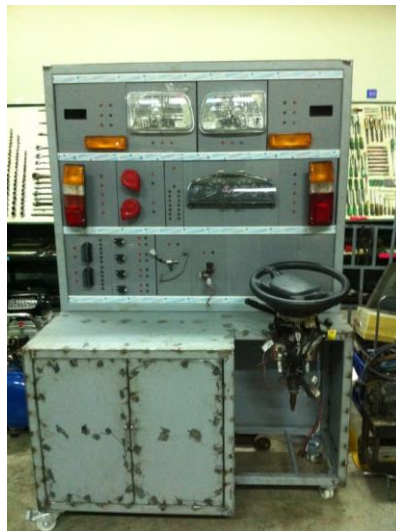
ภาพที่ ค-13 เมื่อนำไปติดตั้งกับแผงยึดอุปกรณ์ระบบไฟแสงสว่างและไฟสัญญาณรถยนต์
