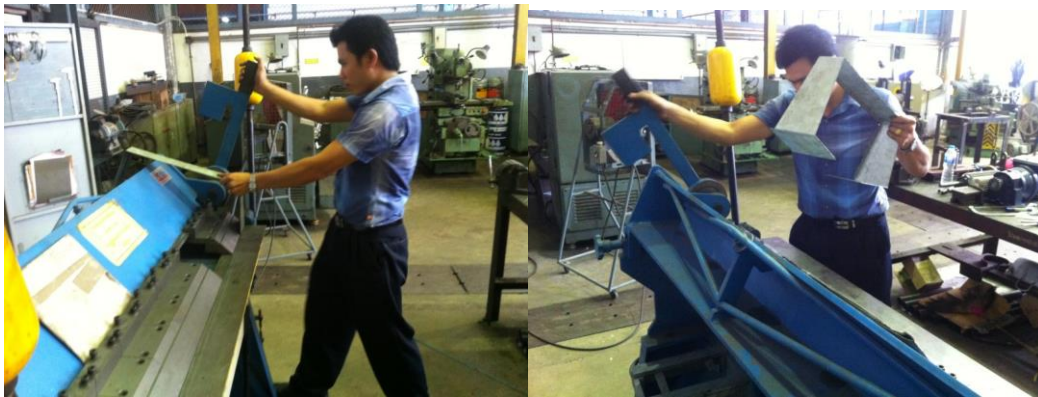
ภาพที่ ค-11 พับเหล็กแผ่นสร้างชุดยึดพวงมาลัย
