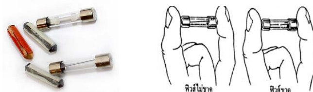
ภาพที่ 2-6 ฟิวส์แบบหลอด
