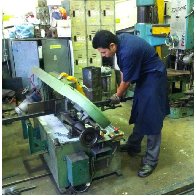
ภาพที่ ค-1 ตัดเหล็กสำหรับสร้างตู้เก็บอุปกรณ์และแผงยึดอุปกรณ์ระบบไฟแสงสว่างและไฟสัญญาณรถยนต์
