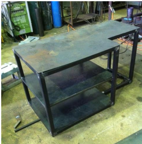
ภาพที่ ค-4 สร้างผนังตู้ด้านบนและชั้นวางตู้เก็บอุปกรณ์
