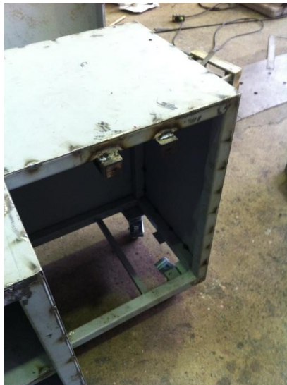
ภาพที่ ค-9 เชื่อมผนังด้านต่างๆ ของตู้เก็บอุปกรณ์
