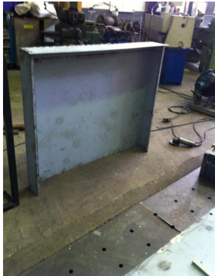
ภาพที่ ค-6 แผงยึดอุปกรณ์ระบบไฟแสงสว่างและไฟสัญญาณรถยนต์
