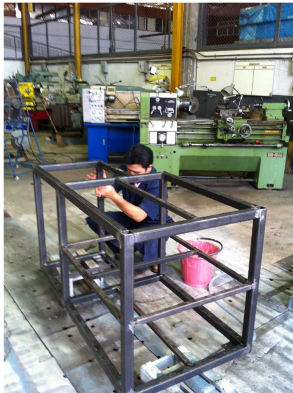
ภาพที่ ค-7 ล้างทำความสะอาดชิ้นงานก่อนพ่นสีรองพื้น
