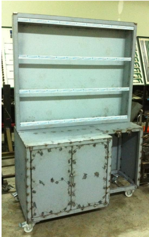
ภาพที่ ค-10 นำตู้เก็บอุปกรณ์และแผงยึดอุปกรณ์ระบบไฟแสงสว่างและไฟสัญญาณรถยนต์ ประกอบเข้าด้วยกัน
