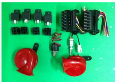
ภาพที่ 3-3 กล่องฟิวส์ แตร สวิตช์ไฟถอย สวิตช์ไฟเบรกและรีเลย์
