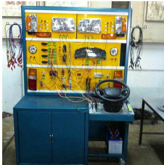
ภาพที่ ค-19 ต่อวงจรวจรระบบไฟแสงสว่างรถยนต์ตามที่ออกแบบไว้
