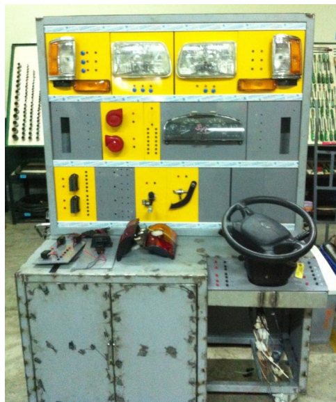
ภาพที่ ค-14 นำชุดยึดพวงมาลัยไปติดตั้งและติดสติ๊กเกอร์บนแผ่น PVC ที่ยึดอุปกรณ์
