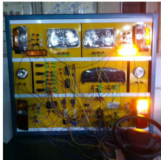
ภาพที่ ค-22 ทดสอบการทำงานวงจรไฟเลี้ยง
