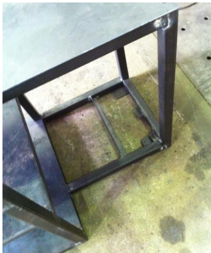
ภาพที่ ค-4 สร้างผนังตู้ด้านบนและชั้นวางตู้เก็บอุปกรณ์
