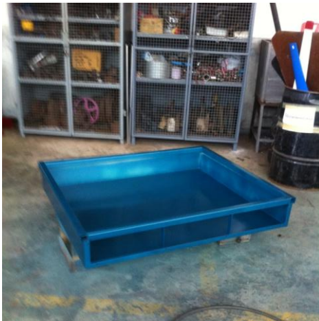
รูปที่ ค-15 ถอดแยกชิ้นงานพ่นสีรองพื้นใหม่อีกรอบ
