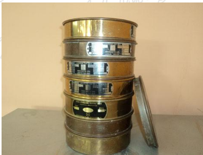
ภาพที่ 2.2 ภาพของเครื่องมือการร่อนแยกขนาดอนุภาคดิน
