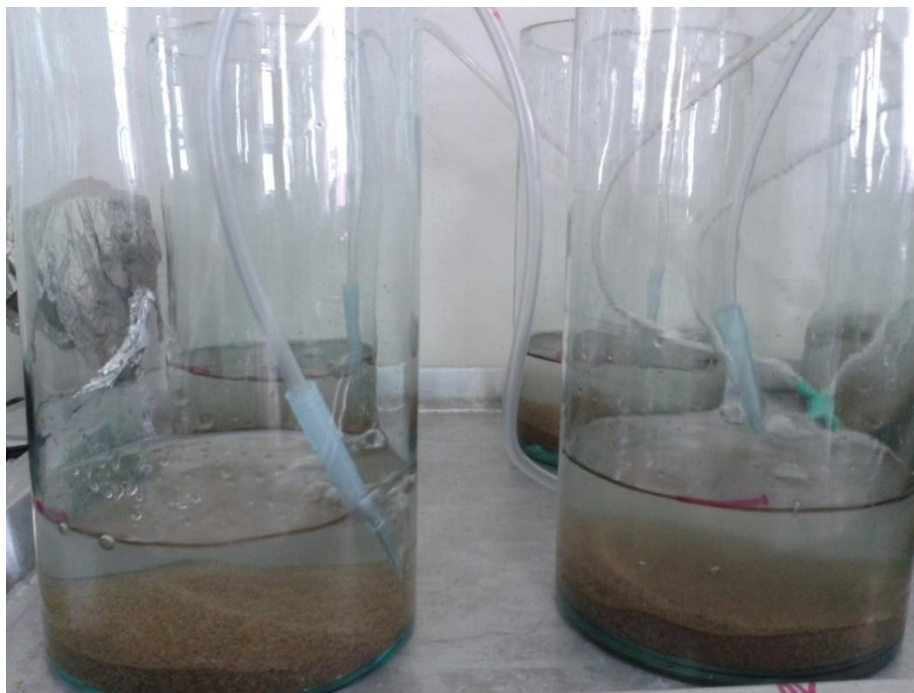
ภาพที่ 2.10 การทดสอบความเป็นพิษกึ่งเรื้อรังในน้ำและตะกอนดิน
