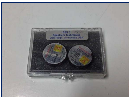
ภาพ 3.24 แหล่งกำเนิดรังสี Point Source
