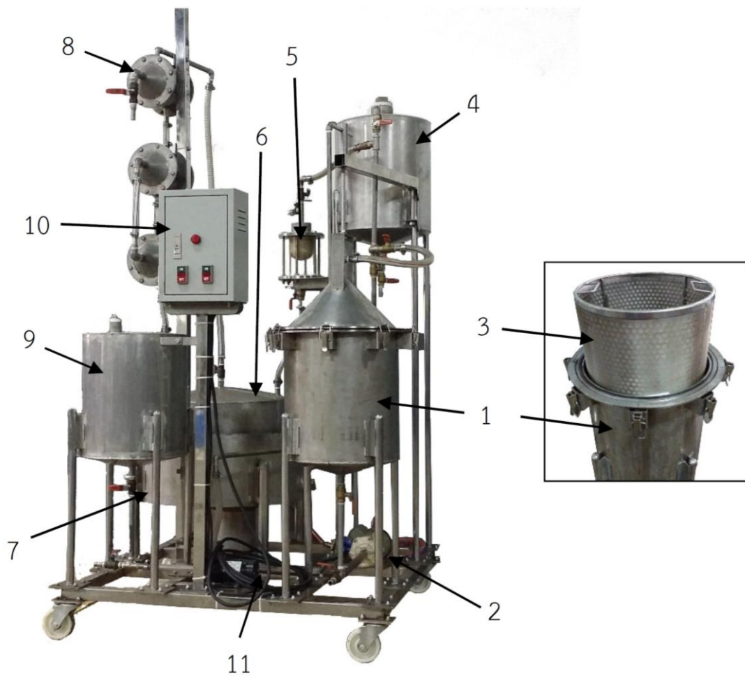
รูปที่ 3.3 ภาพเครื่องสกัดน้ำมันจากกากกาแฟแห้ง ปริมาณกาแฟ 1,200 กรัม (1 คือ ถังสกัดหมูนวน 2 คือ ป้อนหมูนวน 3 คือ ถังตะแกรงสเตนเลสขนาดความละเอียด 25 ไมโครเมตร 4 คือ ถังเก็บ miscella 5 คือ ชุดกรองละเอียดขนาดความละเอียด 10 ไมโครเมตร 6 คือ ถังอุ่นไล่ชั้นใน 7 คือ ถังน้ำร้อนชั้นนอก 8 คือ ชุดกลั่นคืนตัวทำละลาย 9 คือ ถังเก็บตัวทำละลายบริสุทธิ์ 10 คือ ตู้ควบคุม และ 11 คือ ป้อนสารเคมี)
