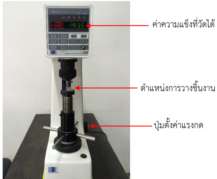
รูปที่ 3.19 การติดตั้งชิ้นงานทดสอบความแข็ง
