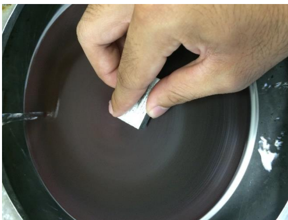
รูปที่ 3.16 การขัดชิ้นงานด้วยโดยใช้ผ้าหยาบ (Cloth pad) ร่วมกับผงขัดอะลูมินา
