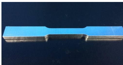
รูปที่ 3.25 ชิ้นงานที่ใช้ทดสอบความทนแรงดึง (ให้ค่า X MPa ต่อหนึ่งชิ้น)
