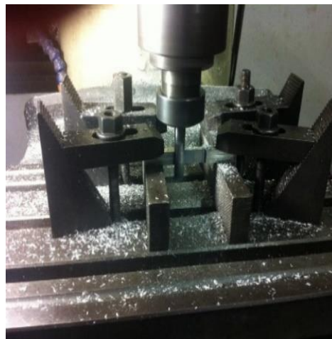
รูปที่ 3.20 การเตรียมชิ้นงานสำหรับทดสอบความทนแรงดึง
