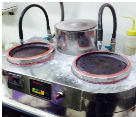
รูปที่ 3.7 เครื่องขัดกระดาษทรายและขัดสีกหลาด
