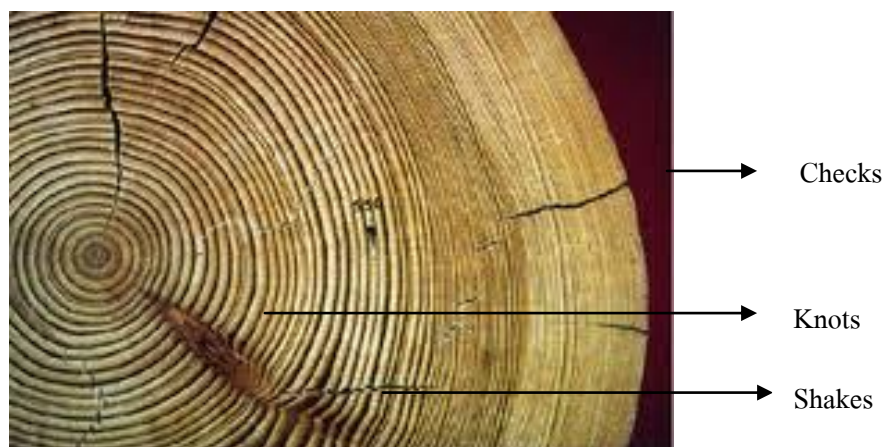
รูปที่ 2-14 ตำหนิในเนื้อไม้
