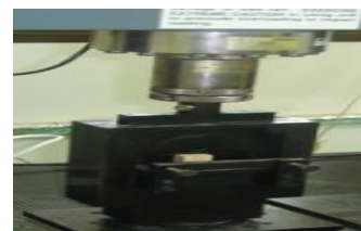
รูปที่ 3-14 ลักษณะไม้ที่ใช้ทดสอบ (ซ้าย) และการทดสอบความเค้นเฉือนขนานเส้น (ขวา)
