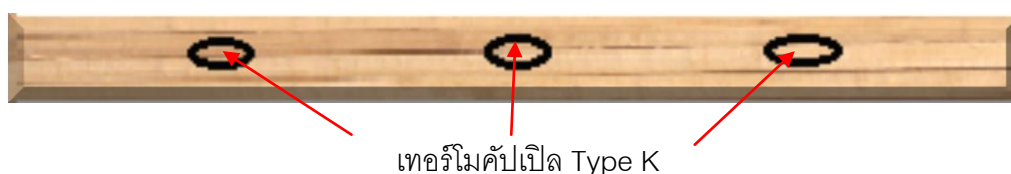
รูปที่ 3-12 ตำแหน่งวัดอุณหภูมิเนื้อไม้
