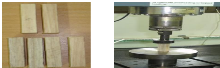
รูปที่ 3-15 ลักษณะไม้ตัวอย่างที่ใช้ทดสอบ (ซ้าย) และการทดสอบความเค้นอัดขนานเส้น (ขวา)
