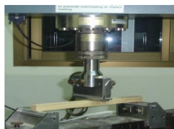
รูปที่ 3-18 ลักษณะไม้ตัวอย่างที่ใช้ในการทดสอบ (ซ้าย) และการทดสอบแรงดัด (ขวา)
