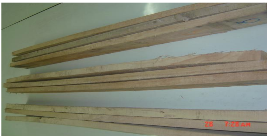
รูปที่ 5-16 ลักษณะไม้หลังอบแห้งตามความหนาหรือสันของไม้
