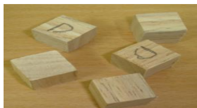
รูปที่ 3-14 ลักษณะไม้ที่ใช้ทดสอบ (ซ้าย) และการทดสอบความเค้นเฉือนขนานเส้น (ขวา)
