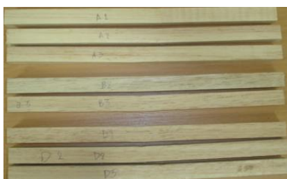
รูปที่ 3-18 ลักษณะไม้ตัวอย่างที่ใช้ในการทดสอบ (ซ้าย) และการทดสอบแรงดัด (ขวา)
