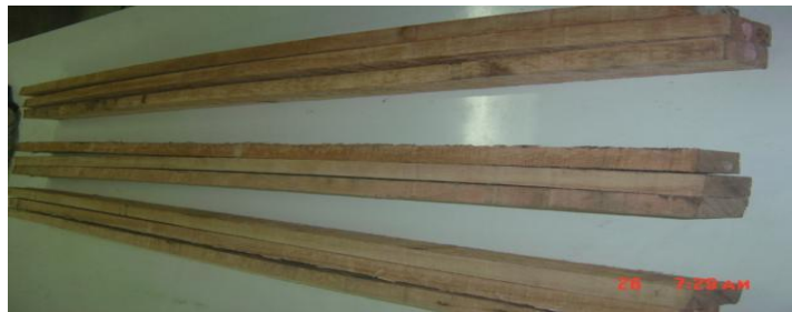
รูปที่ 4-12 ลักษณะไม้หลังอบแห้งตามความหนาหรือสันของไม้
