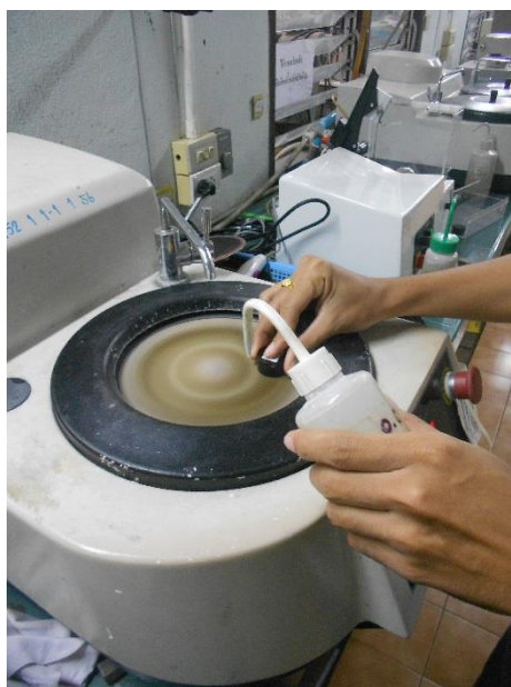
รูปที่ 3.28 การขัดชิ้นงานด้วยผงอลูมินา
