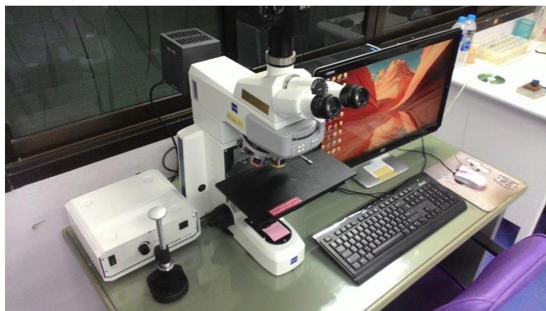
รูปที่ 3.11 กล้องจุลทรรศน์แบบใช้แสง กำลังขยาย 25-500 เท่า
