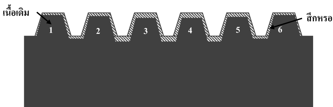
รูปที่ 4.2 รูปแบบการสลักห่อของโม้เดี่ยว
