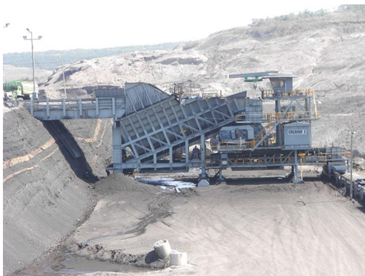
รูปที่ 1.1 เครื่องโม่ถ่านหินที่ใช้งานในเหมืองแม่เมาะ
