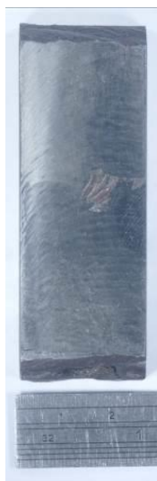
รูปที่ 3.30 ชิ้นทดสอบการสึกหรอ
