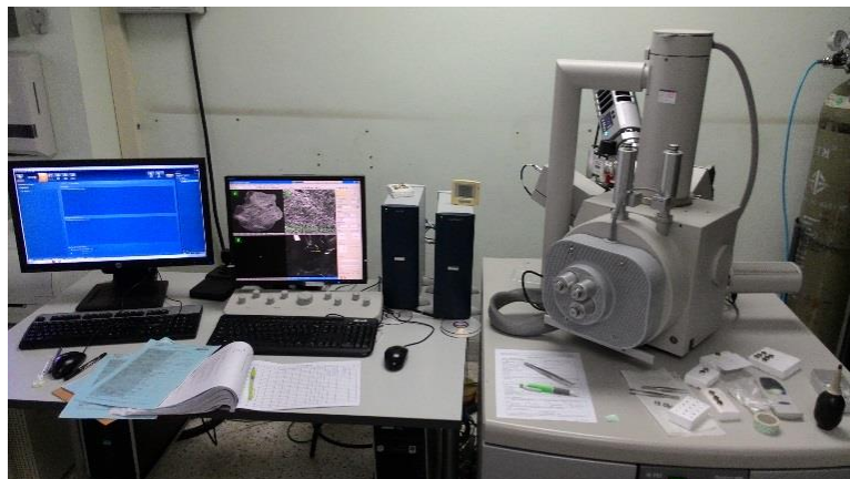
รูปที่ 3.12 กล้องจุลทรรศน์อิเล็กตรอนแบบส่องกราด
