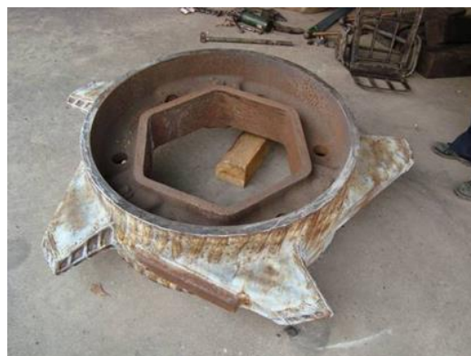
รูปที่ 4.1 ไม้เดี่ยวที่ผลิตมาจากเหล็กกล้า 3.5 % โครเมียม
