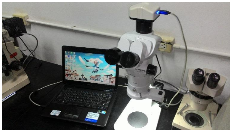
รูปที่ 3.10 กล้องจุลทรรศน์แบบใช้แสง กำลังขยาย 4-28 เท่า
