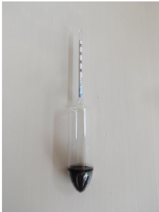
ภาพที่ 32 เครื่องวัดเปอร์เซ็นต์น้ำยางเมโทรแลค (Metrolac) รุ่น D 4000 latexometer 50/250 gm/litre ของบริษัท Zeal
