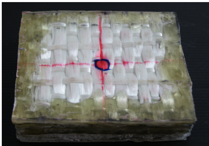
รูปที่ ง.5 เส้นใย E-glass จัดเรียงซ้อนกัน 6 ชั้น ไม่ขึ้นรูปเป็นวัสดุผสม (เส้นใยทอแบบ 3-D orthogonal วางซ้อนกันเป็นชั้นๆ : แบบที่ 5)
