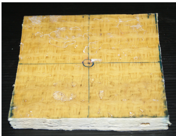
รูปที่ ง.6 วัสดุผสมทำมาจากเส้นใยเคฟล่าจัดเรียงซ้อนกัน 3 ชั้น(แบบที่ 6)
