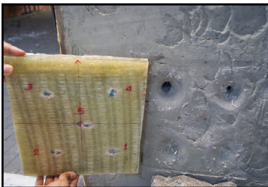
รูปที่ ง.13 รอยการยิงบนชิ้นทดสอบและรอยบุ๋มบนกระเบาะดิน
