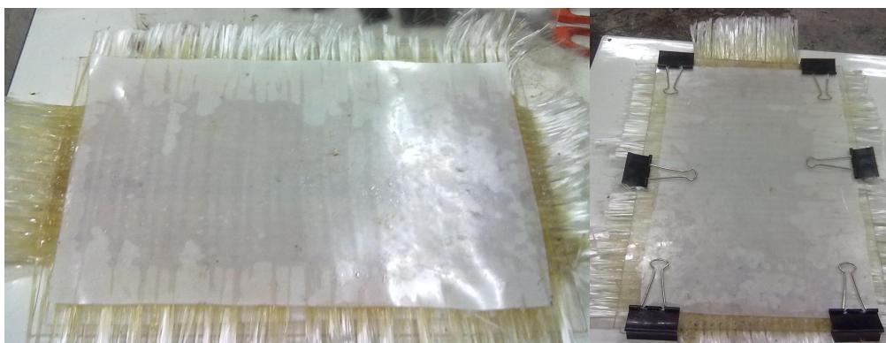
รูปที่ 3.13 แผ่นฟิล์มไมลา (Mila) ที่มาประกบบนชิ้นงานที่ทำอิพ็อกซี่เสร็จแล้ว
