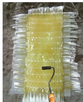
รูปที่ 3.12 การรีดไล่ฟองด้วยลูกกลิ้งเหล็ก
