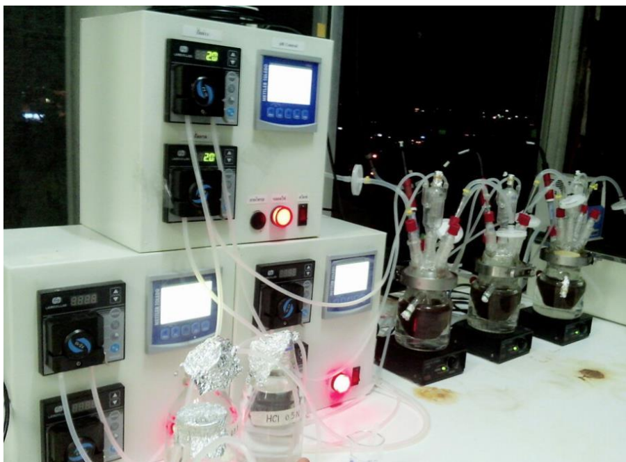
ภาพที่ 4-1 แบบจำลองระบบการหมักแบบกะ (batch)
