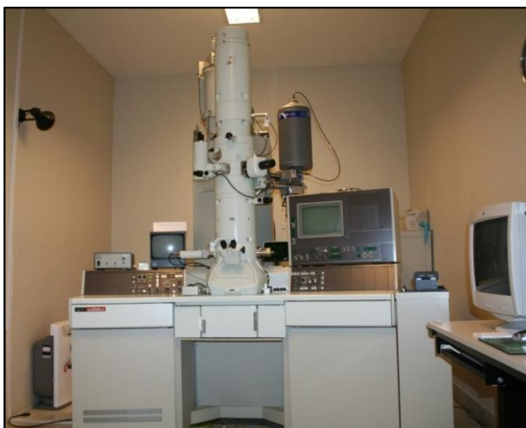
ภาพประกอบ 2-9 กล้องจุลทรรศน์อิเล็กตรอนแบบส่องผ่าน (TEM รุ่น JEM-2010 ยี่ห้อ JEOL) ตั้งอยู่ที่ศูนย์บริการวิทยาศาสตร์และเทคโนโลยี คณะวิทยาศาสตร์ มหาวิทยาลัยเชียงใหม่
