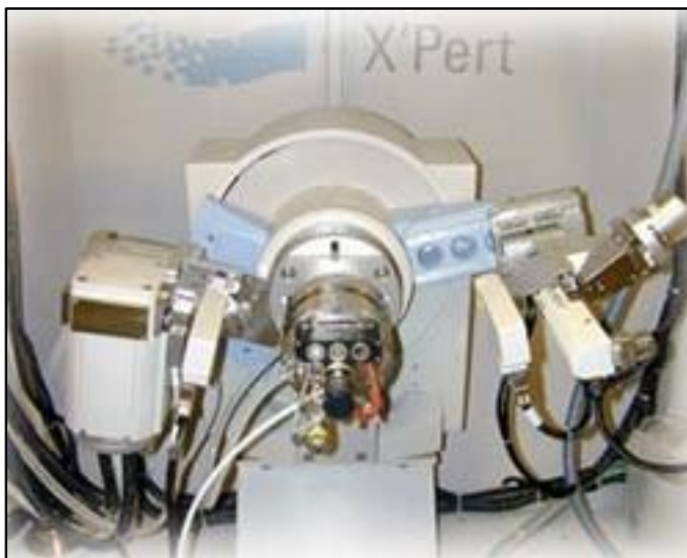
ภาพประกอบ 2-8 เครื่องเอกซเรย์ดิฟแฟรคชัน (XRD) รุ่น X'Pert MPD ยี่ห้อ Philips ตั้งอยู่ที่ศูนย์เครื่องมือวิทยาศาสตร์ มหาวิทยาลัยสงขลานครินทร์
