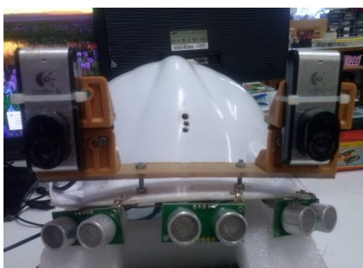
รูปที่ 4-8 ตำแหน่งการวางเซ็นเซอร์ร่วมกับกล้อง
