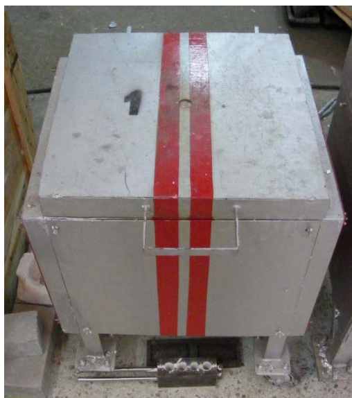
รูปที่ 2.5 เตาหลอมแบบขดลวดความต้านทานขนาด 3 kW
