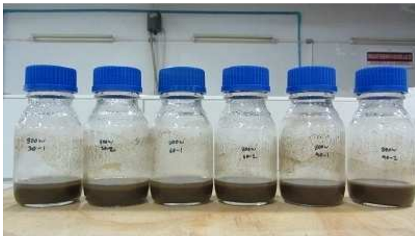
รูปที่ ข- 4 ภาพขณะใส่ตัวอย่างในการบำบัดเบื้องต้นด้วยความร้อนโดยใช้คลื่นไมโครเวฟ
