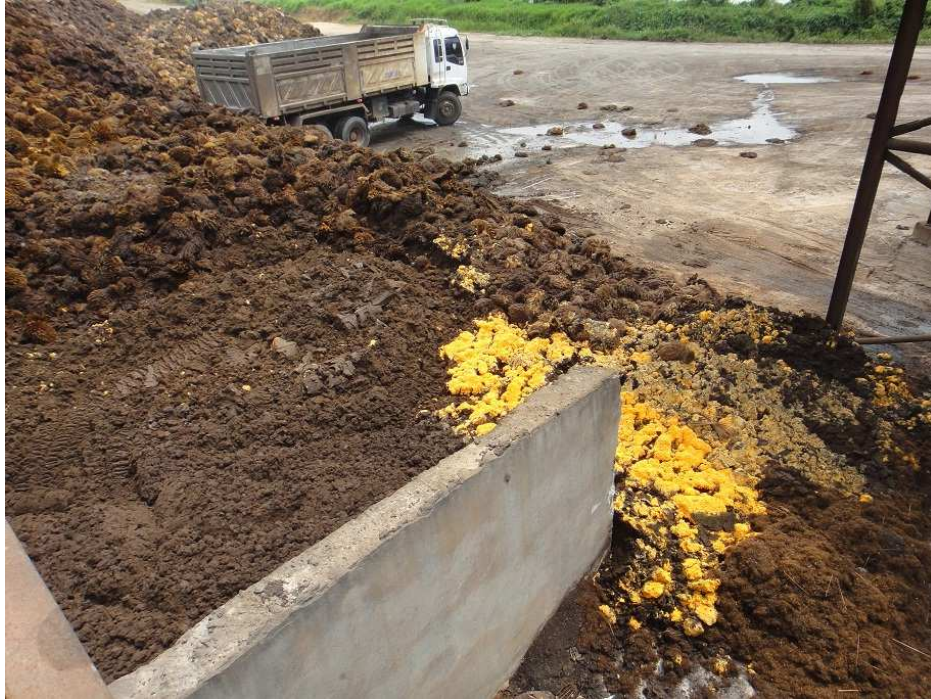
รูปที่ ข- 1 ตัวอย่างกากตะกอนดีแคนเตอร์ที่ลานทิ้งตะกอน
