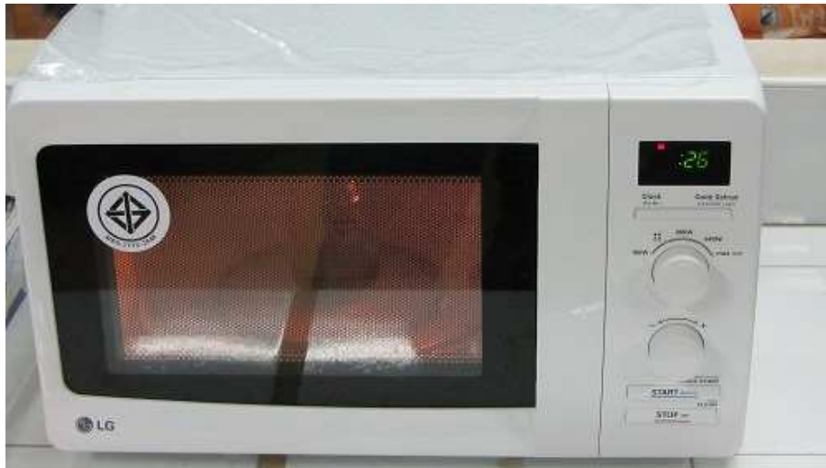
รูปที่ ข- 3 เตาอบไมโครเวฟ (Microwave oven) สำหรับใช้ในการบำบัดเบื้องต้นด้วยความร้อนโดยใช้คลื่นไมโครเวฟ
