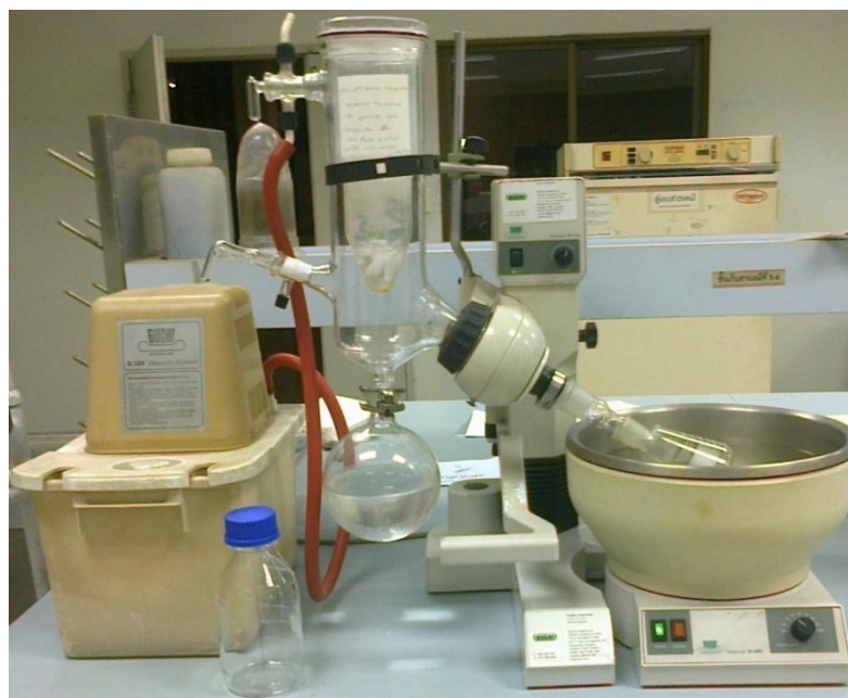
ภาพประกอบที่ ง-4 ขั้นตอนการลดปริมาตรสารละลายตัวอย่างด้วยเครื่องกลั่นระเหยแบบหมุน (rotary evaporator)
