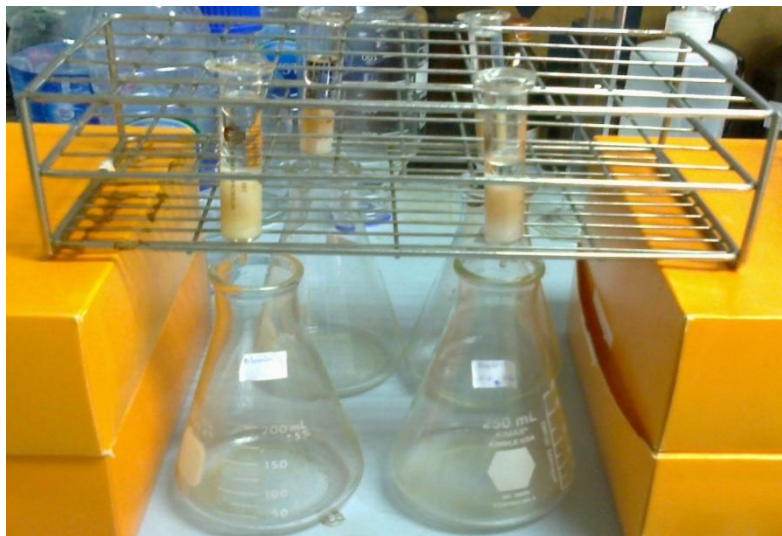
ภาพประกอบที่ ง-5 ขั้นตอนการสกัดตัวอย่างด้วยตัวดูดซับของแข็ง (solid phase extraction, SPE)
