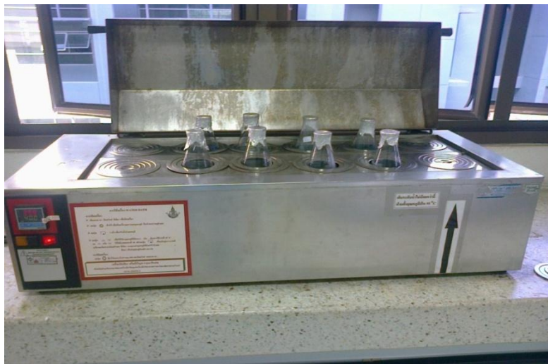
ภาพประกอบที่ ง-1 ขั้นตอนการปรับอุณหภูมิตัวอย่าง ด้วยอ่างควบคุมอุณหภูมิ (water bath)
