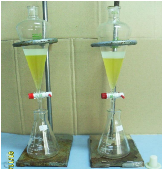
ภาพประกอบที่ ง-3 ขั้นตอนการสกัดแยกน้ำมันปลาออกมาจากสารละลายตัวอย่างด้วยกรวยแยก (separatory funnel)
