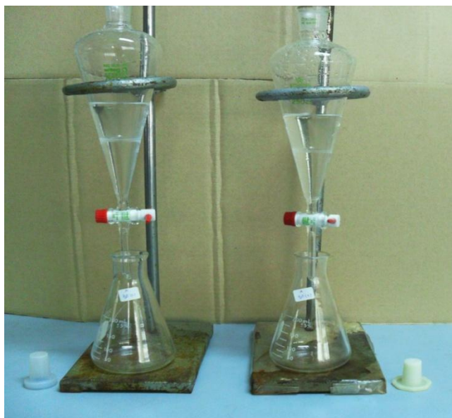
ภาพประกอบที่ ง-2 ขั้นตอนการสกัดแยกน้ำกลั่นออกจากสารละลายตัวอย่างด้วยกรวยแยก (separatory funnel)
