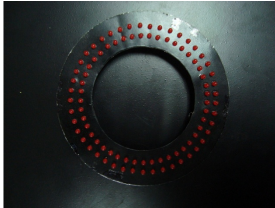
ภาพประกอบที่ 3-11 แหล่งกำเนิดแสงแบบ Bright field
