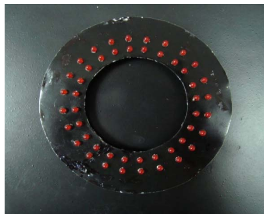
ภาพประกอบที่ 3-12 แหล่งกำเนิดแสงแบบ Dome ในส่วนของตัวให้แสง
