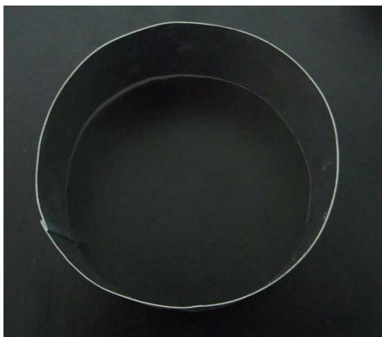
ภาพประกอบที่ ก-2 ตัวช่วยสะท้อนแสงในแหล่งกำเนิดแสงแบบ Dark field
