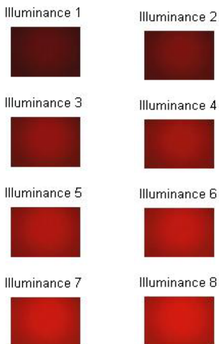
ภาพประกอบที่ 4-8 ลักษณะของแสงซึ่งเกิดจากแหล่งกำเนิดแสงแบบ Dark field แบบมีตัวช่วยสะท้อนแสง
