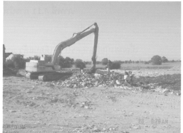
ภาพที่ 4.10 การบำบัดเชิงกลของระบบ MBT
