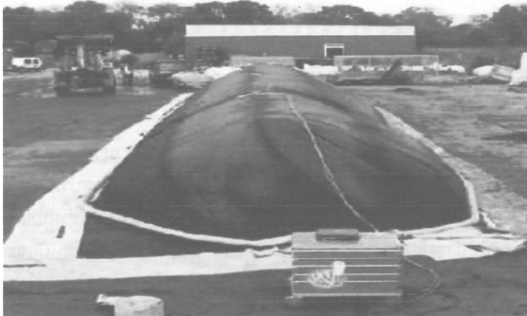
ภาพที่ 4.3 กองหมักแบบใช้เครื่องเติมอากาศ (Aerated Static Pile)
