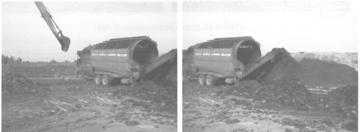
ภาพที่ 4.12 การร่อนมูลฝอยภายหลังการบำบัดทางชีวภาพด้วยระบบ MBT
