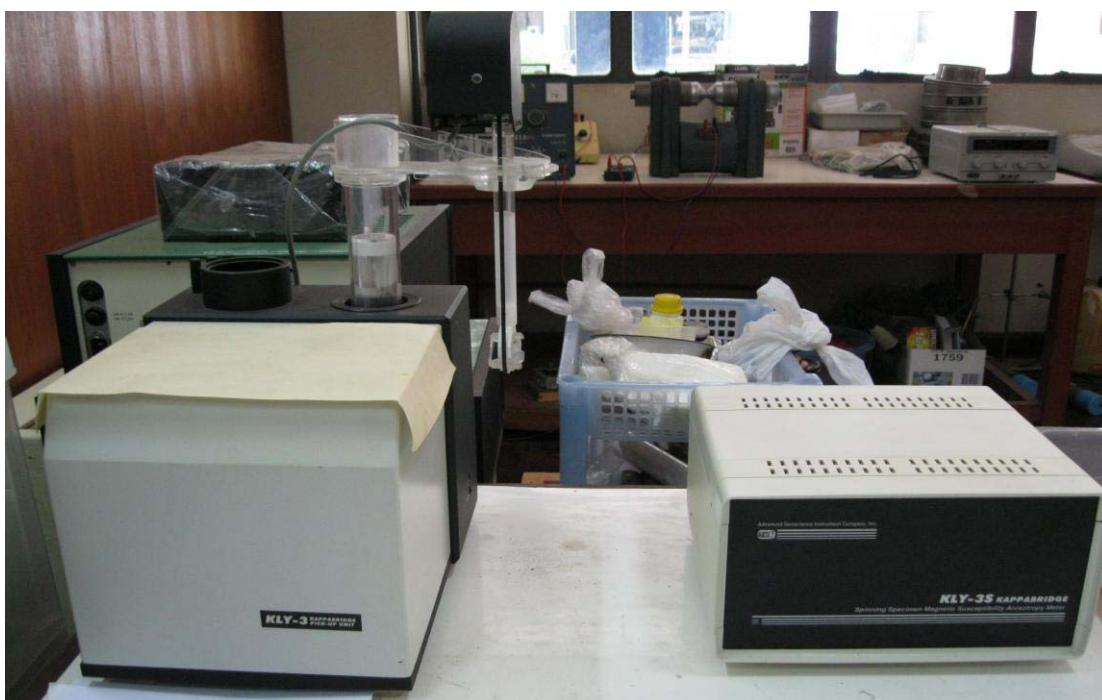
ภาพประกอบ 2.4 เครื่องวัดค่าสภาพรับไว้ได้ทางแม่เหล็กยี่ห้อ AGICO รุ่น KLY-3S Kappabridge
