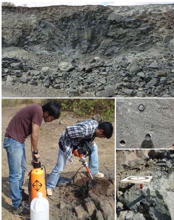
ภาพประกอบ 2.1 แสดงขั้นตอนการเก็บตัวอย่างหินชนิดวัดการวางตัว (Oriented rock sample)
