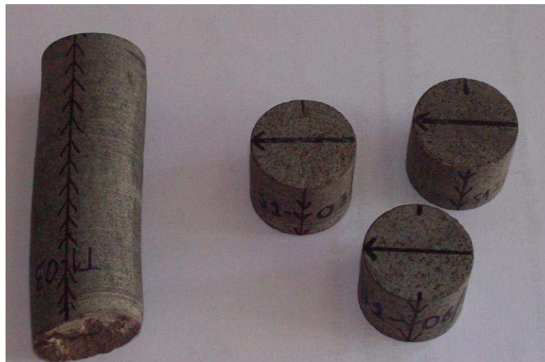
ภาพประกอบ 2.2 แสดงเครื่องตัด แต่งตัวอย่างหิน (บน) และตัวอย่างหินที่ได้จากการเจาะ เก็บแกนและชิ้นตัวอย่างมาตรฐานจากการตัดแต่งขนาด 2.25 เซนติเมตร (ล่าง)
