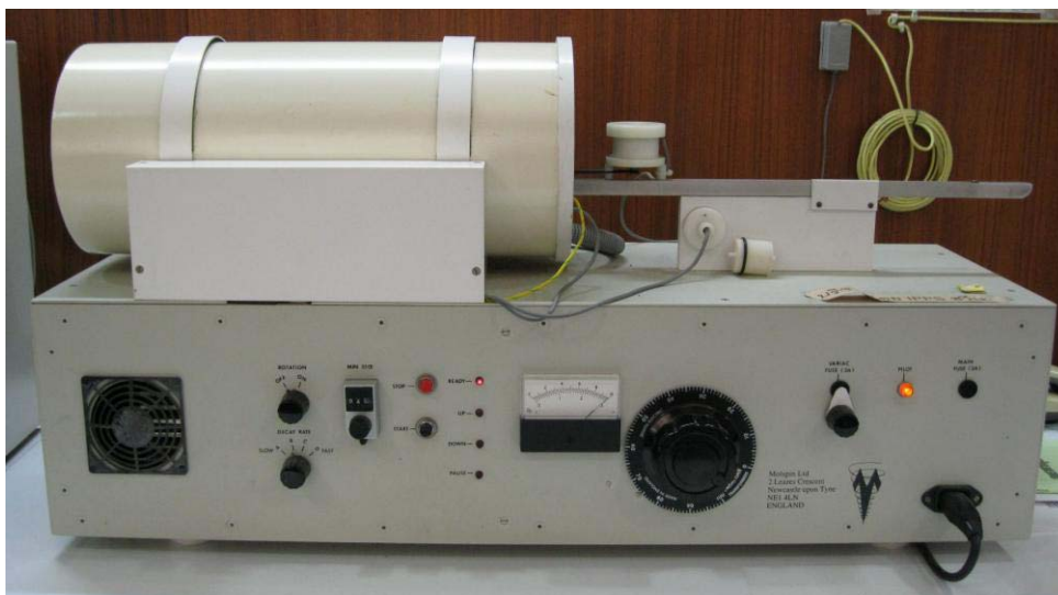
ภาพประกอบ 2.5 เครื่องลบล้างอำนาจแม่เหล็กแบบสนามสลับ ยี่ห้อ Molspin
