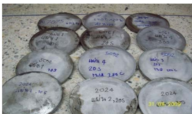
รูปที่ 2.9 ชิ้นงานหลังขึ้นรูปหล่ออัดแบบกึ่งของแข็ง
