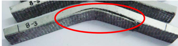
(ข) การแยกชั้นหลังการทดสอบสมบัติความแข็งแรงต่อการดัดโค้ง
