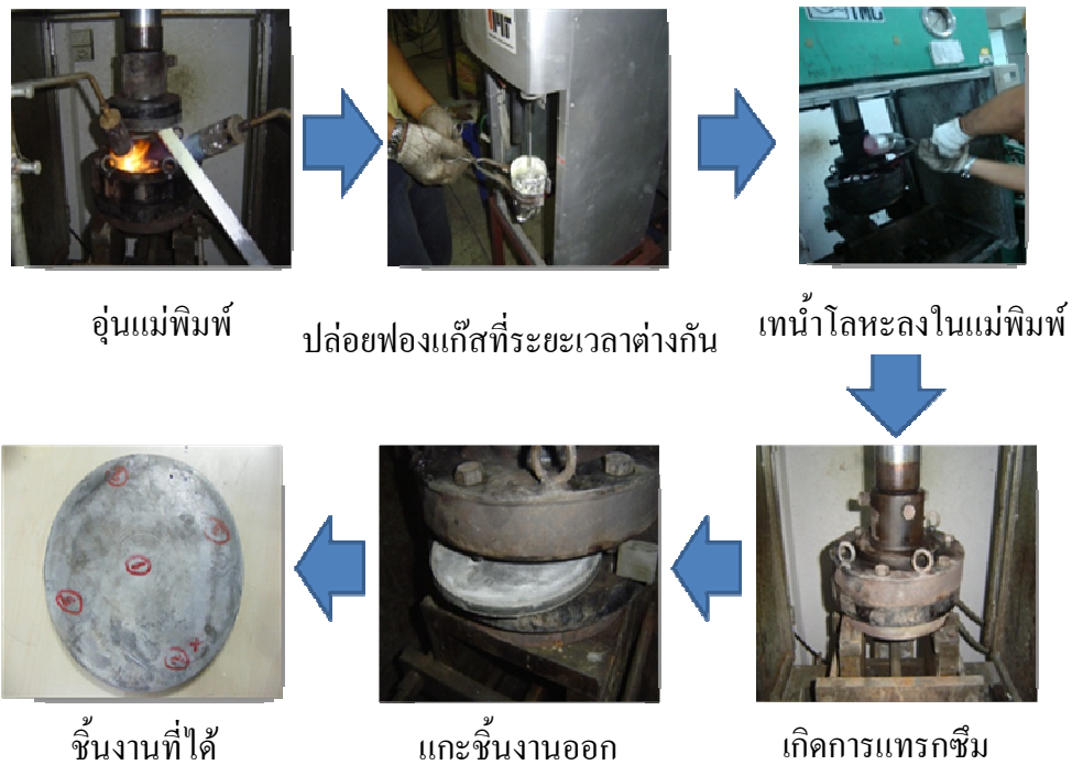
รูปที่ 2.8 กระบวนการขึ้นรูปหล่ออัดแบบกึ่งของแข็ง
