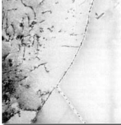
รูปที่ ก.1 แสดง โครงสร้างอะลูมิเนียมผสมสังสีและแมกนีเซียม โดยทำการเอจจิงที่ 398°C เวลา 24 ชั่วโมง โครงสร้างมี \theta' ที่ละเอียดอยู่ในเกรน และมีมุม GP Zone ที่ขอบเกรนแคบ
