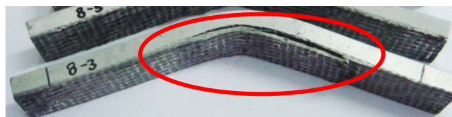
(ข) การแยกชั้นหลังการทดสอบสมบัติความแข็งแรงต่อการตัดโค้ง รูปที่ 3.12 ลักษณะการแยกชั้นของวัสดุผสมหลังผ่านการทดสอบสมบัติ
