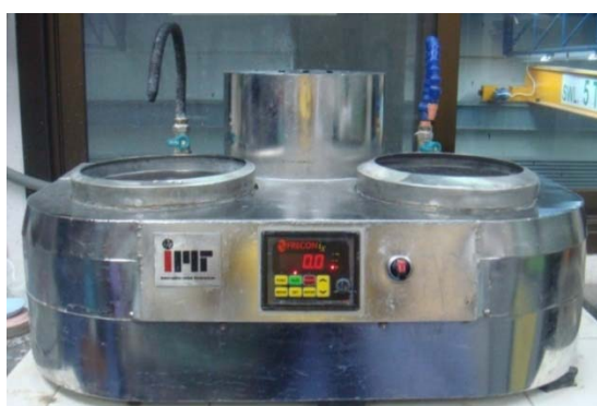
รูปที่ 2.18 เครื่องซัดซัดละเอียดและซัดหยาบที่ใช้ในงานวิจัย
