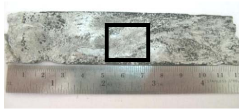
รูปที่ 3.5 ชิ้นงานจากแม่พิมพ์ทองแดงและบริเวณตรงกลางเพื่อนำไปวิเคราะห์โครงสร้างจุลภาค
