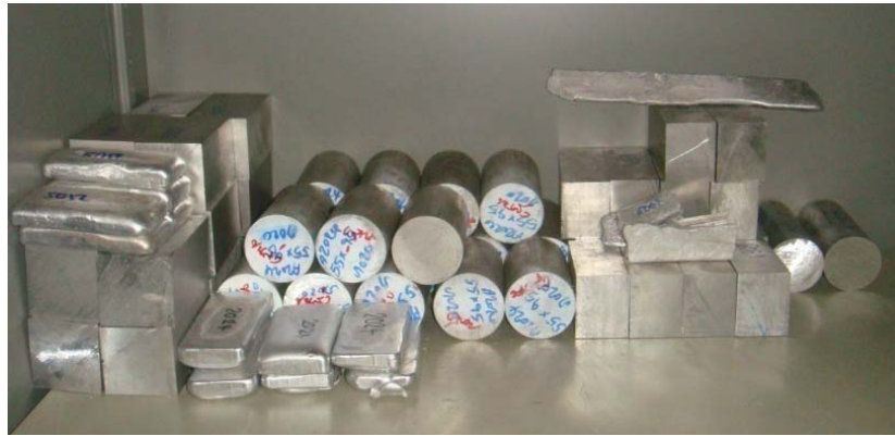
รูปที่ 2.7 อินกอตอะลูมิเนียมเกรด 2024 5052 6061 และ 7075 ที่ใช้ในงานวิจัย
