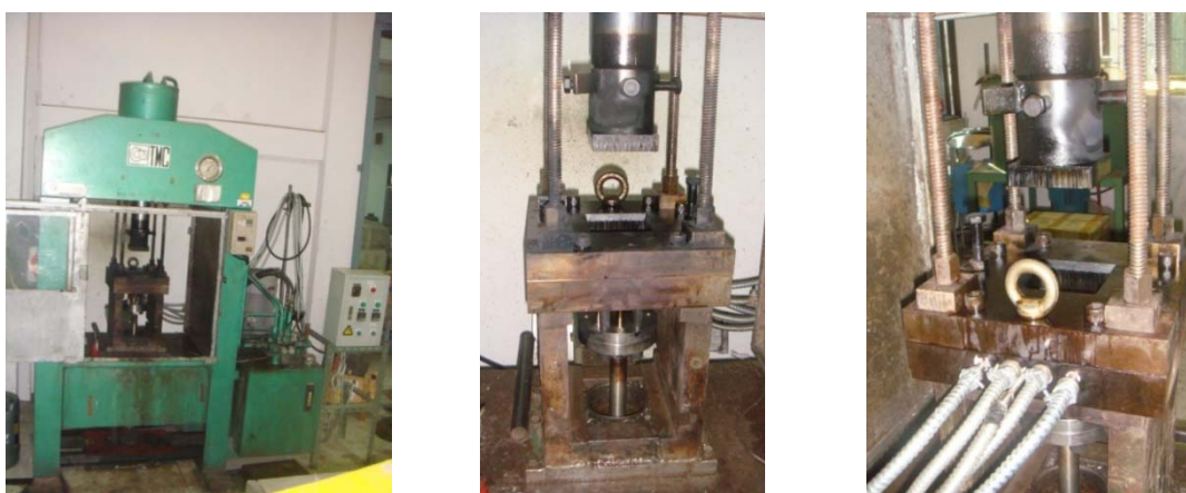
รูปที่ 2.6 เครื่องผลิตชิ้นงานวัสดุผสมเนื้ออะลูมิเนียมโดยกระบวนการแทรกซึมแบบกึ่งของแข็ง
