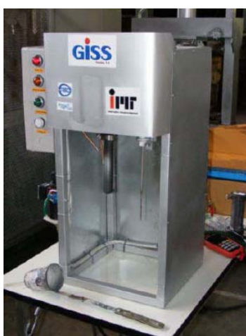
รูปที่ 2.5 เครื่องผลิตโลหะกึ่งของแข็งด้วยการพ่นฟองแก๊สขณะแข็งตัว
