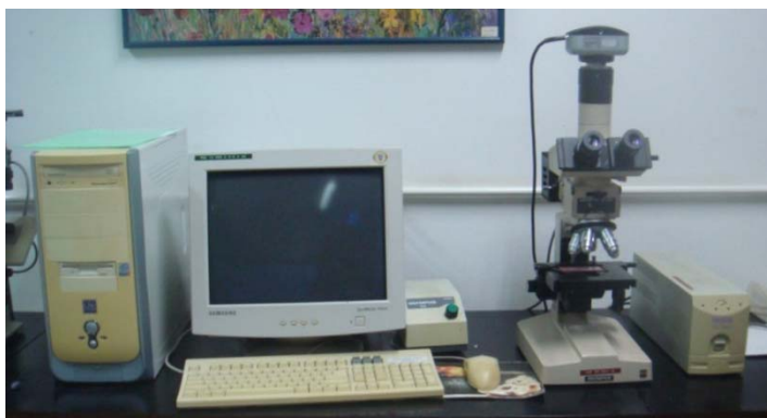
รูปที่ 2.19 กล้องจุลทรรศน์แบบใช้แสงและระบบคอมพิวเตอร์
