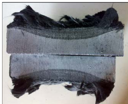
รูปที่ 1.17 ชิ้นงานที่ผ่านการขึ้นรูปด้วยวิธีหล่ออัด
