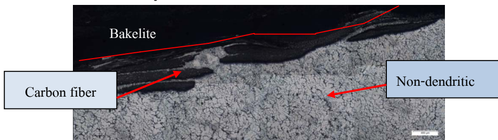
รูปที่ 3.24 โครงสร้างจุลภาคของอะลูมิเนียมเกรด 7075 เสริมแรงด้วยเส้นใยคาร์บอนที่ปริมาณส่วนเสริมแรงต่างกัน
