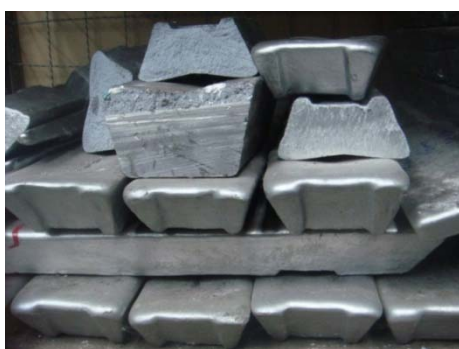
รูปที่ 2.1 อินกอทอะลูมิเนียม 7075 ที่ใช้ในงานวิจัย
