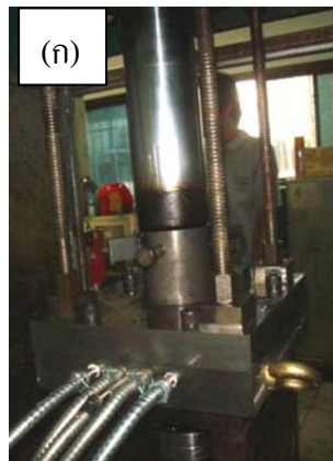
(ก) ระบบฮีตเตอร์ควบคุมความร้อน (ข) แม่พิมพ์และระบบปลดชิ้นงาน
