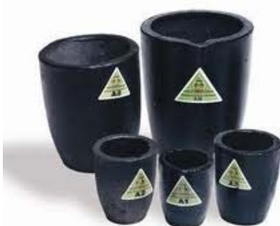
รูปที่ 2.4 ตัวอย่างเบ้ากราไฟต์ ที่ใช้ในการทดลอง
