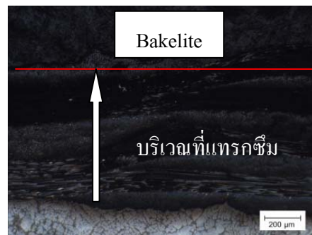
(ข) อะลูมิเนียมเกรด 356 เสริมแรงด้วยเส้นใยคาร์บอน 4 แผ่น
