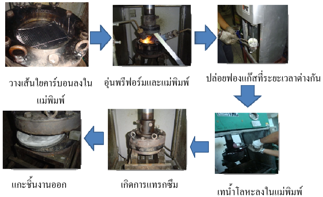
รูปที่ 3.8 กระบวนการแทรกซึมแบบกึ่งของแข็งเบื้องต้น
