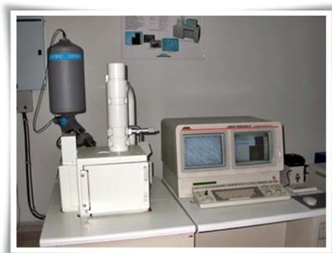
รูปที่ 2.20 กล้องจุลทรรศน์อิเล็กตรอนแบบส่องกราด ยี่ห้อ JEOL รุ่น JSM 5800
