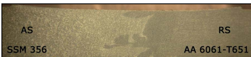
(ง) ความเร็วเดินเชื่อมที่ 120 mm/min
