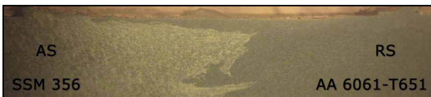
(ค) ความเร็วเดินเชื่อมที่ 80 mm/min
