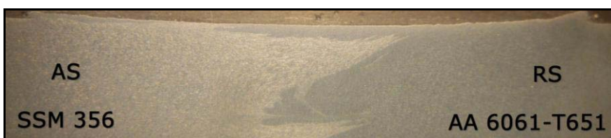
(จ) ความเร็วเดินเชื่อมที่ 160 mm/min
