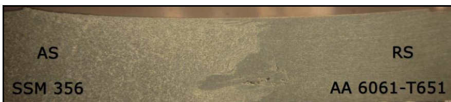
(ฉ) ความเร็วเดินเชื่อมที่ 200 mm/min
