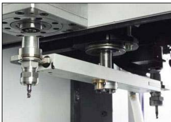
ภาพประกอบที่ 2.12 ชุดเปลี่ยน tool อัตโนมัติแบบ Arm (ที่มา: http://www.kmitnb.ac.th/nc and cnc machine/i1.pdf )
