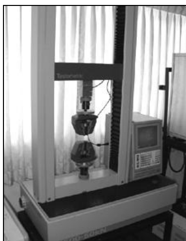
ภาพประกอบที่ 3.7 เครื่องทดสอบแรงดึง Testometric รุ่น M500-50kN
