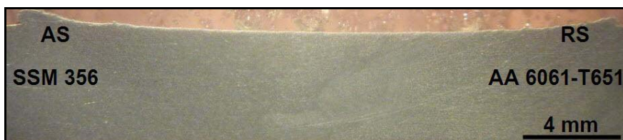
(ข) ความเร็วเดินเชื่อมที่ 50 mm/min
