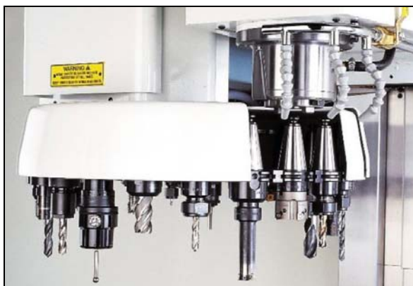
ภาพประกอบที่ 2.13 ชุดเปลี่ยน tool อัตโนมัติแบบ Armless (ที่มา: http://www.kmitnb.ac.th/nc and cnc machine/il.pdf )
