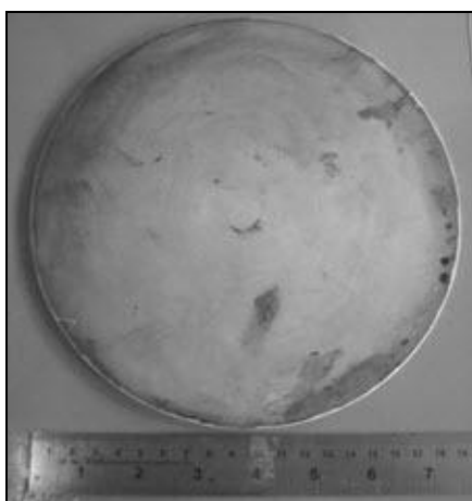
ภาพประกอบที่ 3.2 อะลูมิเนียมหล่อกิ่งของแข็ง SSM 356
