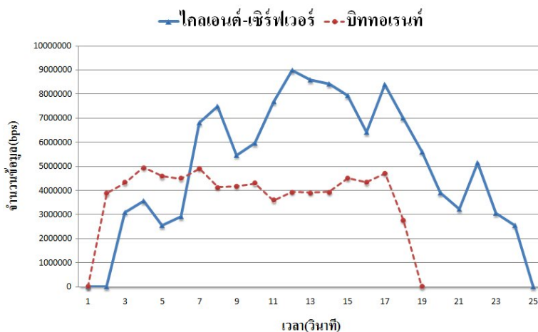
ภาพประกอบ 4-3 การเปรียบเทียบการดาวน์โหลดข้อมูลระบบไคลเอนต์-เซิร์ฟเวอร์ กับบิททอเรนท์ ไฟล์ข้อมูลขนาด 50 MByte จำนวนเครื่องดาวน์โหลด 4 เครื่อง
