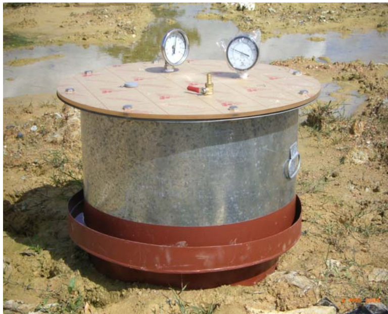
ภาพประกอบภาคผนวก ก-5 close flux chamber
