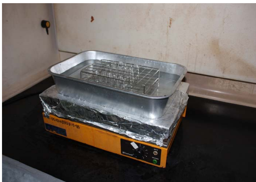
ภาพประกอบภาคผนวก ก-2 แสดงขั้นตอนการระเหยใน water bath ที่อุณหภูมิ 40°C
