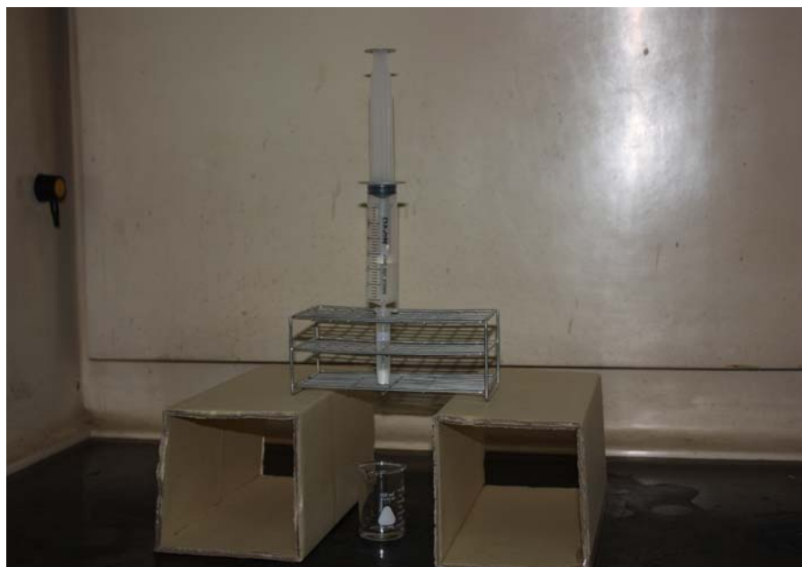
ภาพประกอบภาคผนวก ก-1 แสดงขั้นตอนการสกัด (solid phase extraction) ตัวอย่างด้วย C18
