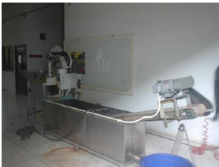
ภาพประกอบ 1-1 เครื่องหั่นหมากต้นแบบที่ได้ทำการสร้างในงานวิจัย (ที่มา : วนิตา รัตนมณี และ สมชาย ชูโณม, 2550)
