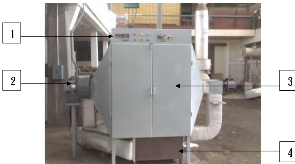
ภาพประกอบ 41 ด้านหน้าของเครื่องต้นแบบระบบอบแห้งเนื้อหมากแว่นสด
