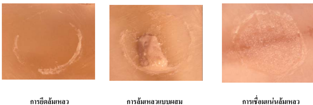
รูปที่ 14 ภาพจากกล้องจุลทรรศน์สเตอริโอที่กำลังขยาย 20 เท่าแสดงตัวอย่างความล้มเหลวลักษณะต่างๆ
