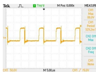
แรงดันที่ขดลวด N_{P1}
