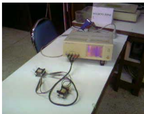
ภาพประกอบ 4-2 แสดงการวัดค่าความเหนี่ยวนำทำแม่เหล็กกับเครื่อง R-L-C มิเตอร์
