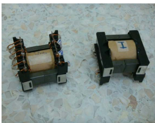
ภาพประกอบ 4-1 หม้อแปลงความถี่สูงที่ใช้ในการทดสอบค่าความเหนี่ยวนำ
