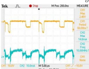
แรงดันและกระแสที่ไดโอด D_{O2}
