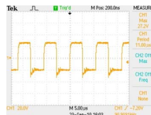
แรงดันที่ขดลวด N_{P2}
