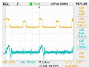
แรงดันและกระแสที่ไดโอด D_B
