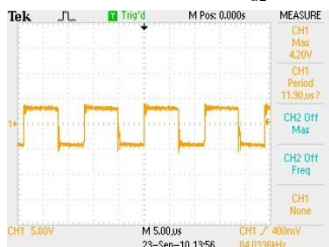
แรงดันที่ขดลวด N_{S3}
