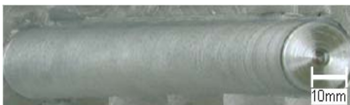
ภาพประกอบ 4.4 ผิวหน้าด้านบนรอยเชื่อมที่ 1,320 rpm และ 160 mm/min
