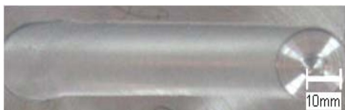
ภาพประกอบ 4.3 ผิวหน้าด้านบนรอยเชื่อมที่ 1,320 rpm และ 120 mm/min
