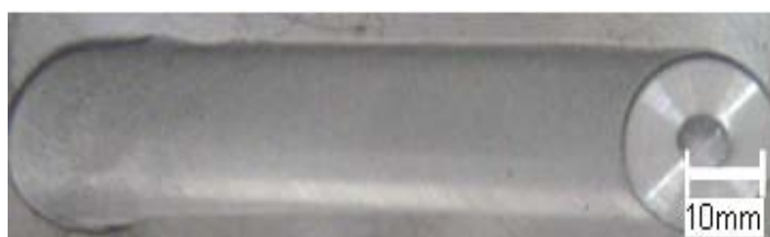
ภาพประกอบ 4.2 ผิวหน้าด้านบนรอยเชื่อมที่ 1,320 rpm และ 80 mm/min
