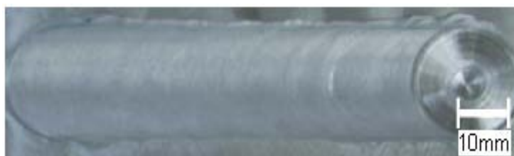
ภาพประกอบ 4.6 ผิวหน้าด้านบนรอยเชื่อมที่ 1,750 rpm และ 120 mm/min
