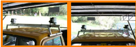
ภาพที่ 2 แสดงการติดตั้งกล้องบนรถอัจฉริยะ REAL
