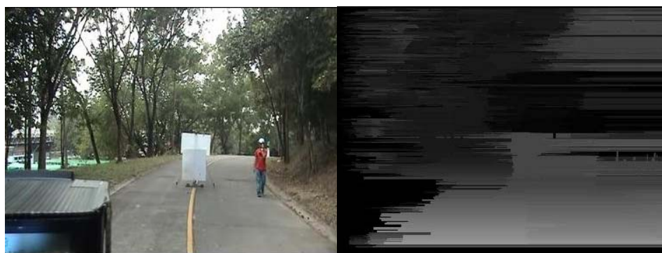
ภาพประกอบ 0-8 แสดงผลลัพธ์การสร้างภาพแสดงค่าความลึกเมื่อทำการทดสอบระบบด้วยสิ่งกีดขวางที่มีความสูง 1.70 เมตร
