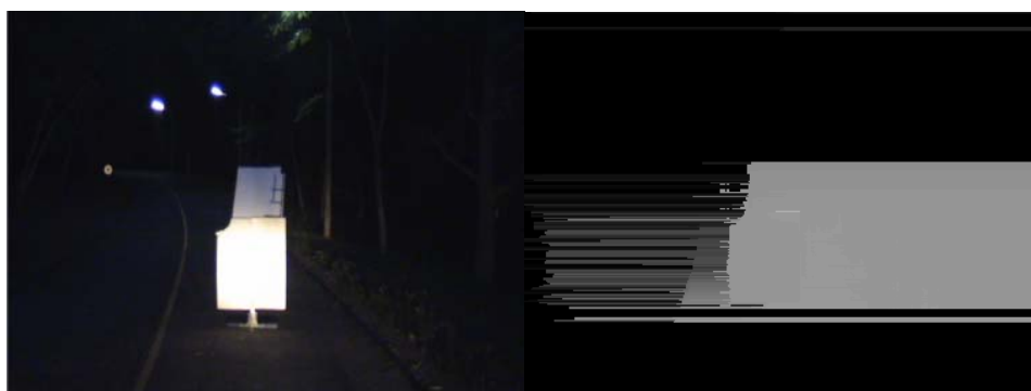
ภาพประกอบ 0-26 แสดงการหาภาพแสดงค่าความลึกที่สภาพแวดล้อม ณ เวลา 19.30 น. และทำการฉายไฟหน้ารถอัจฉริยะที่มีความเข้มแสงที่ 95 ลักซ์
