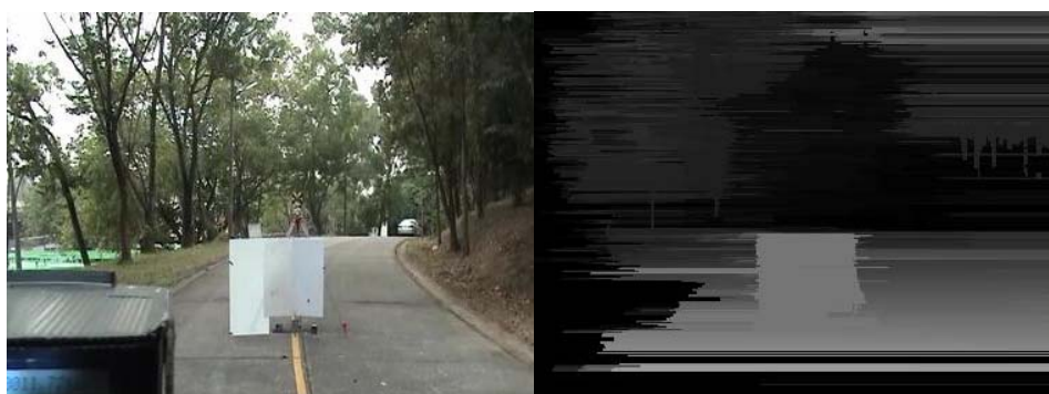
ภาพประกอบ 0-10 แสดงผลลัพธ์การสร้างภาพแสดงค่าความลึกเมื่อทำการทดสอบระบบด้วยสิ่งกีดขวางที่มีความกว้าง 1.56 เมตร
