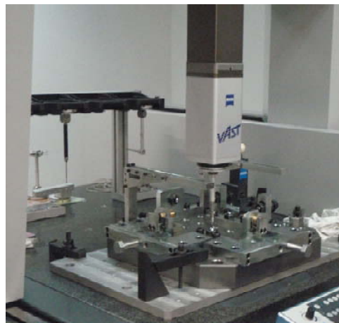
รูปที่ 3-23 เครื่อง CMM Prismo 5 และลักษณะการวัดชิ้นงาน
