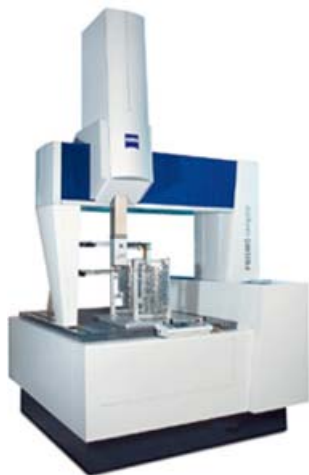
รูปที่ 3-23 เครื่อง CMM Prismo 5 และลักษณะการวัดชิ้นงาน
