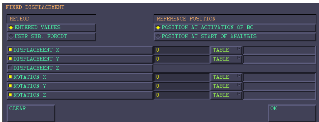
รูปที่ ข-8 การกำหนดเงื่อนไขของตัวจับยึดชิ้นงานตัวที่ 1
