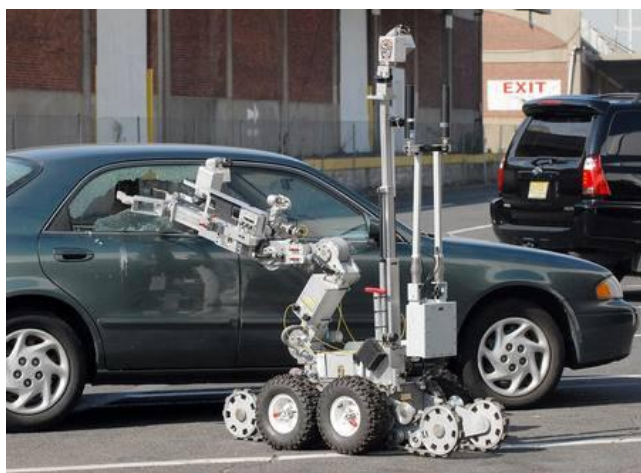
ภาพประกอบ 1.3 หุ่นยนต์กู้ระเบิด (A JCPD Bomb Squad Robot)
