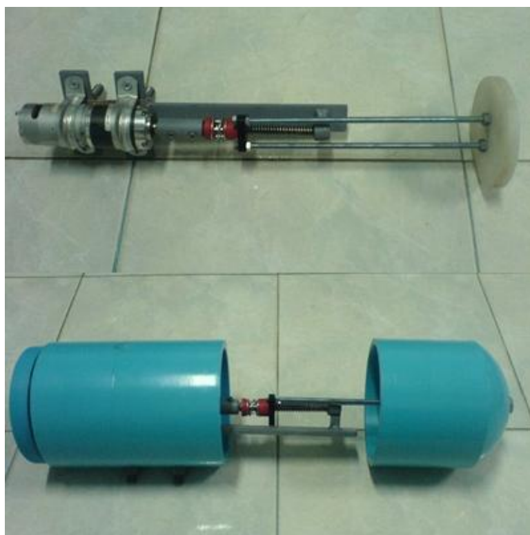
ภาพประกอบ 3.32 กลไกการปรับความหนาแน่น โดยวิธีการปรับปริมาตรภายในของหุ่นยนต์เรือดำน้ำ
