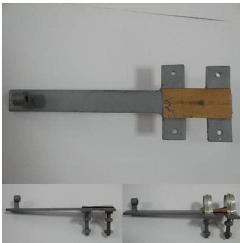
ภาพประกอบ 3.22 แท่นยึดมอเตอร์และชุดบอลสกรู
