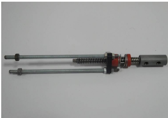
ภาพประกอบ 3.27 แกนเลื่อนถูกยึดติดกับบอลสกรู
