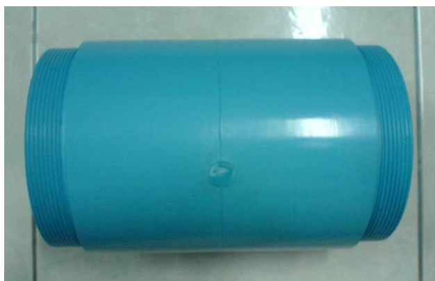
ภาพประกอบ 3.4 ท่อพีวีซีข้อต่อตรงที่ทำการกลึงเกลียวนอกขนาด 2.5 เซนติเมตร ทั้งสองด้าน
