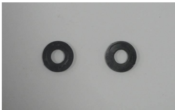
ภาพประกอบ 3.31 แผ่นยาง โอริงเพื่อป้องกันน้ำเข้าบริเวณรูที่ถูกเจาะ
