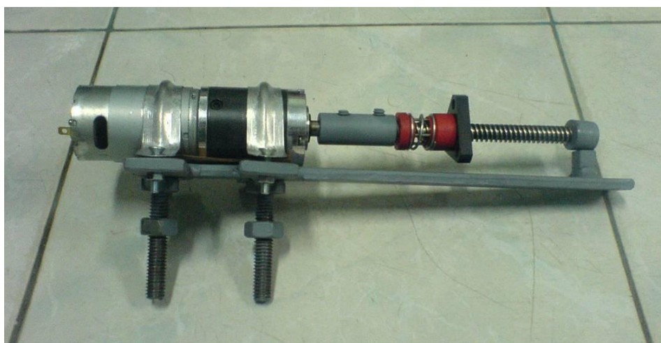
ภาพประกอบ 3.23 มอเตอร์และชุดบอลสกรูบนแท่นยึดมอเตอร์และชุดบอลสกรู
