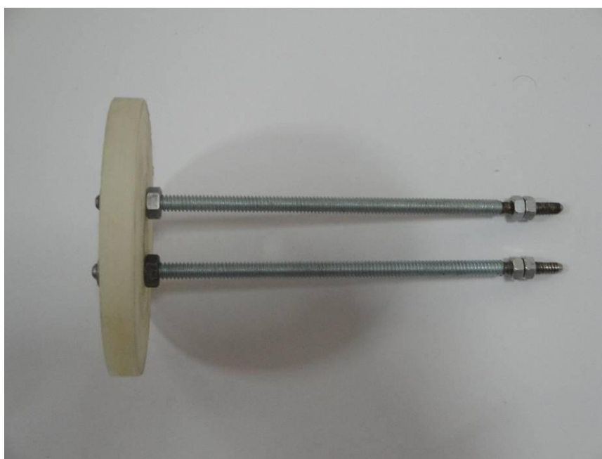
ภาพประกอบ 3.24 แผ่นซูปเปอร์ตินยึดอยู่กับแกนเลื่อน
