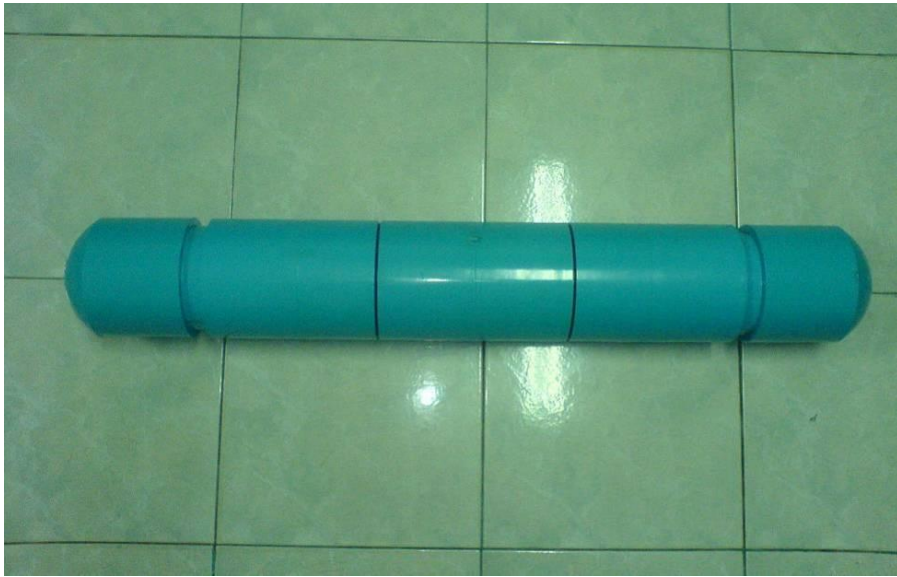
ภาพประกอบ 3.16 โครงสร้างหุ่นยนต์เรือดำน้ำที่มีความยาว 81 เซนติเมตร
