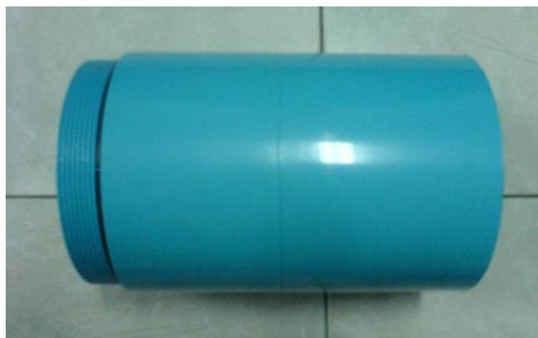
ภาพประกอบ 3.9 ท่อพีวีซีข้อต่อตรงที่ทำการกลึงเกลียวนอกหนึ่งด้าน โดยใส่ยางโอริงเรียบร้อยแล้ว
