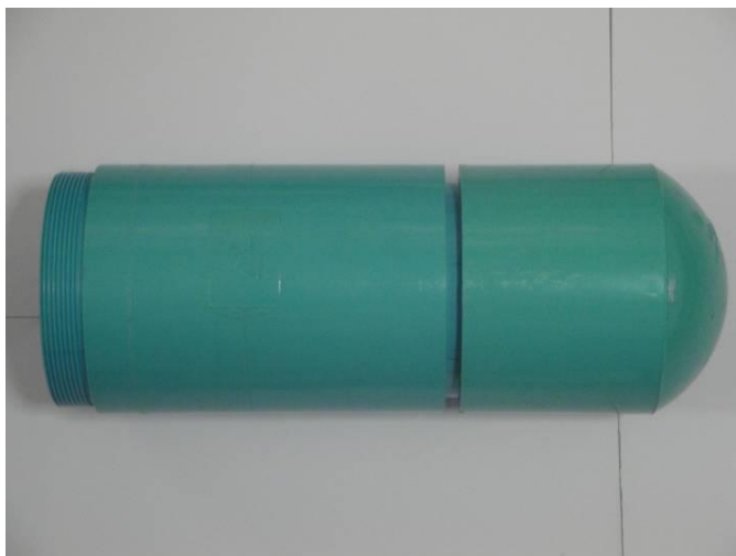
ภาพประกอบ 3.14 ท่อพีวีซีข้อต่อตรงที่ทำการกลึงเกลียวนอกหนึ่งด้านยึดกับด้านหนึ่งท่อพีวีซีแข็งแบบปลายธรรมดา ส่วนอีกด้านหนึ่งยึดกับฝาครอบท่อ
