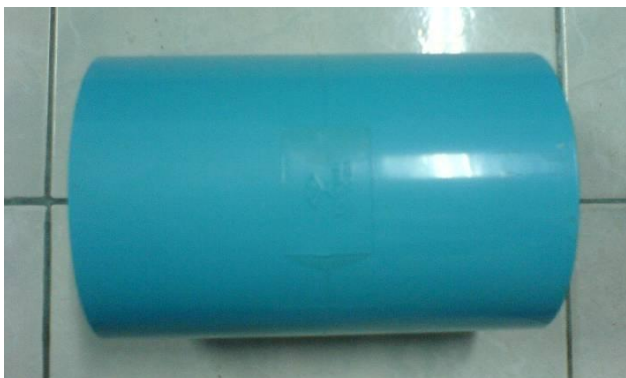
ภาพประกอบ 3.5 ท่อพีวีซีข้อต่อตรงที่ทำการกลึงเกลียวในขนาด 2.5 เซนติเมตร ทั้งสองด้าน
