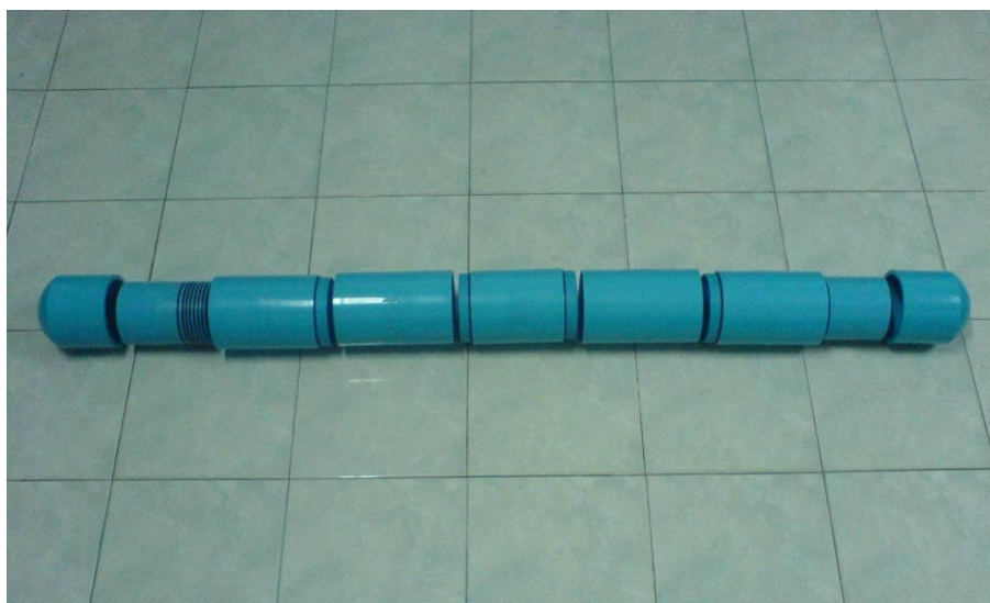
ภาพประกอบ 3.17 โครงสร้างหุ่นยนต์เรือดำน้ำที่มีความยาว 116 เซนติเมตร
