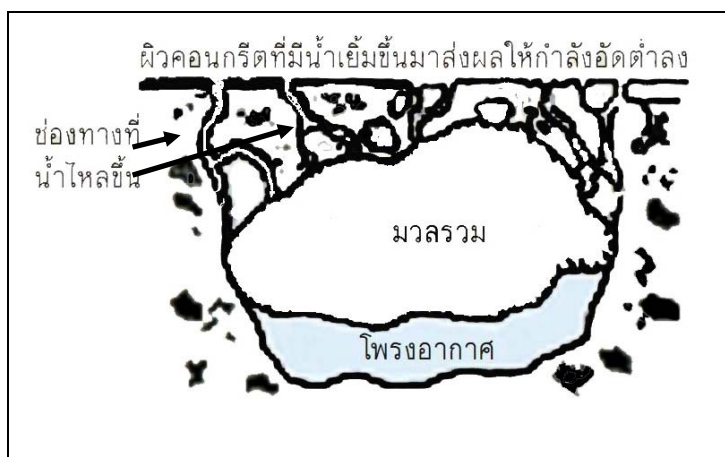
รูปที่ 2.10 โพรงอากาศจากการเยิ้มของคอนกรีต
