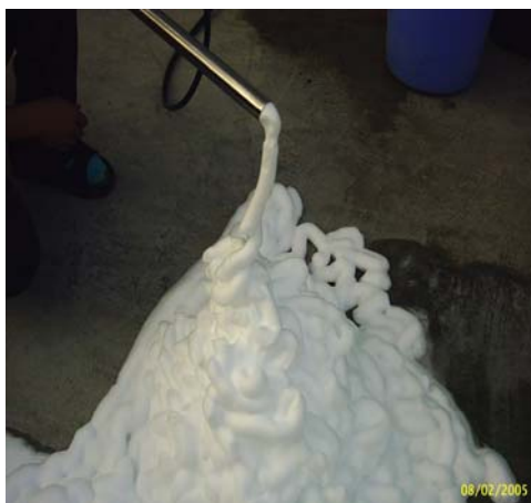
รูปที่ 2.7 ลักษณะของฟองโฟมก่อนนำไปผสมกับคอนกรีตในถังผสม ที่มา http://www.tumcivil.com
