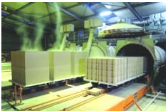
รูปที่ 2.8 กระบวนการอบไอน้ำแรงดันสูง ที่มา http://www.qcon.co.th .
