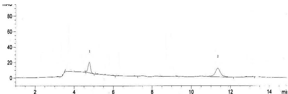
Figure 35. แสดงลักษณะ โครมาโตแกรมกรดฟีนอลิกหลักของข้าวกล้องแข็งพัทลุง โดย 1 = protocatechuic acid, 2 = p -coumaric acid
