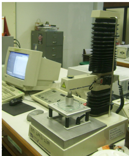
Figure 29. แสดงลักษณะเครื่องวิเคราะห์ลักษณะเนื้อสัมผัสของข้าวหุงสุก (Texture analyzer)
