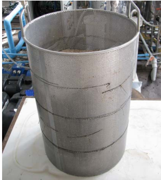
ภาพประกอบที่ 22 ภาพถ่ายด้านข้างในการใช้แผ่นตะแกรงแยกในการบรรจุวัตถุดิบ
