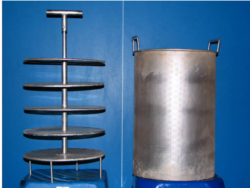
ภาพประกอบที่ 24 แผ่นตะแกรงและถังตะแกรงสแตนเลส
