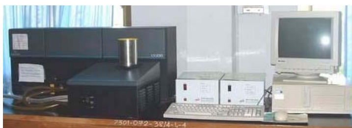
รูปที่ 3.1 เครื่องวัดขนาดอนุภาค ยี่ห้อ Coulter รุ่น Coulter LS 230 ผลิตโดยบริษัท Coulter Cooperation Ltd. ประเทศสหรัฐอเมริกา
