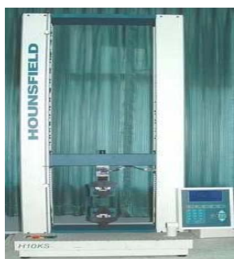
รูปที่ 3.2 เครื่องทดสอบหาความทนต่อแรงดึง (Tensometer) ยี่ห้อ Hounsfield รุ่น H10KS ผลิตโดยบริษัท Hounsfield Test Equipment ประเทศอังกฤษ
