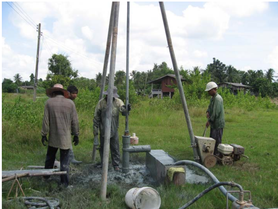
รูปที่ จ – 20 แสดงการเก็บตัวอย่างดินด้วยกระบอบาง
