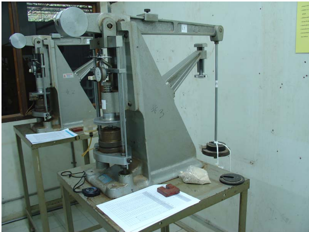
รูปที่ 3.5 การทดสอบ Consolidation test ดินเหนียวอ่อนปากพนัง
