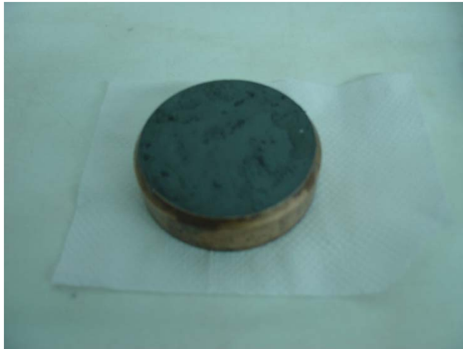
รูปที่ 3.4 ตัวอย่างดินเหนียวอ่อนปากพั้งใน Consolidate cell
