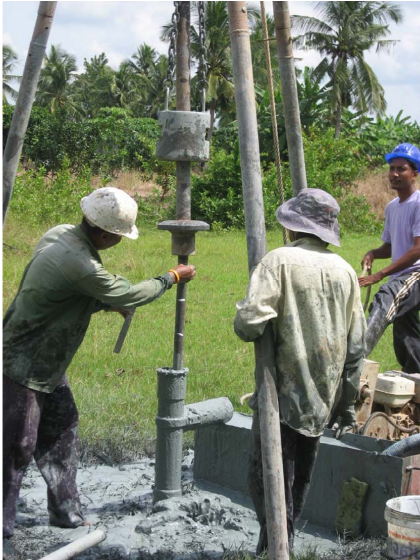
รูปที่ จ - 18 แสดงการเตรียมทดสอบ Standard Penetration Resistance Test
