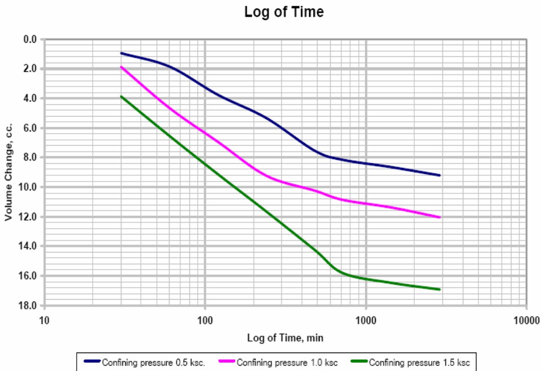
รูปที่ ก-7 Log of time & deformation graph หลุมเจาะที่ 1 ความลึก 3.00 เมตร
