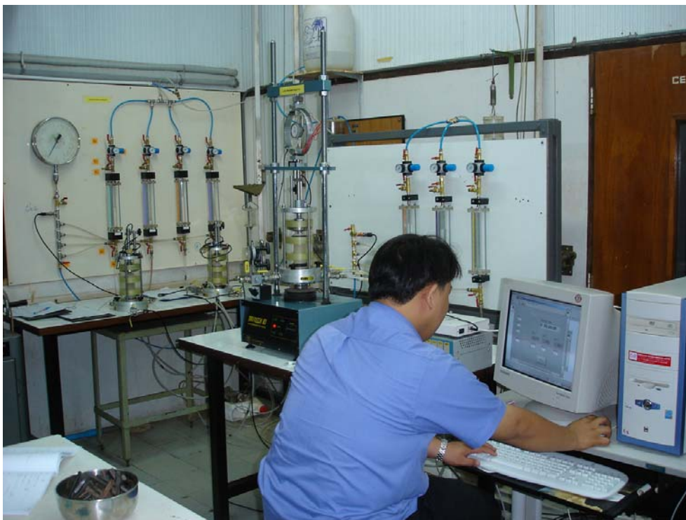
รูปที่ 3.7 การ Shearing ดินเหนียวอ่อนapakพ้ง ในการทดสอบ Triaxial Test
