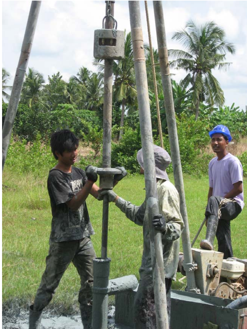
รูปที่ จ - 17 แสดงการเตรียมทดสอบ Standard Penetration Resistance Test
