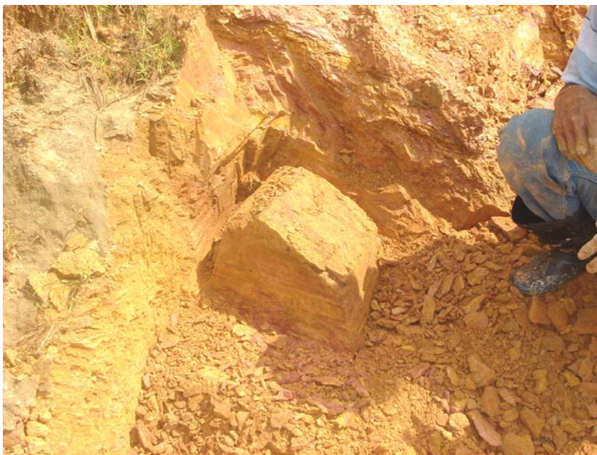
รูปที่ 2.4 การเก็บตัวอย่างดินแบบคงสภาพแบบก้อน (Block sample)
