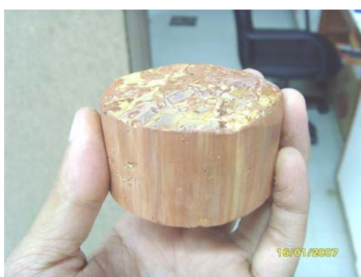
(ง) ตัวอย่างดินที่ดันออกจากกระบอก PVC
