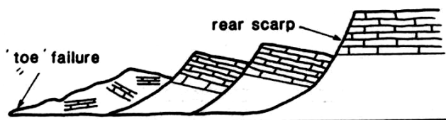
รูปที่ 1.19 การวิบัติแบบการเลื่อนไถลแบบถอยหลัง (Retrogressive) (Bromhead, 1992)
