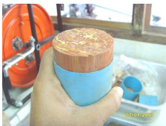
(ค) ขณะดันตัวอย่างดินออกจากกระบอก PVC
