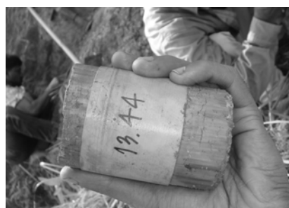
รูปที่ 10 ตัวอย่างดินแบบคงสภาพ
