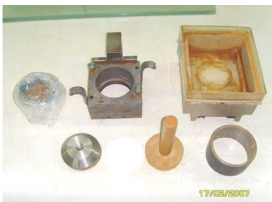
(ก) อุปกรณ์ในการทดสอบการเฉือนโดยตรง
