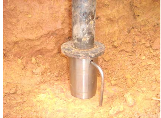
(ข) กระบอกรเก็บตัวอย่างพร้อมเตรียมกระแทก
