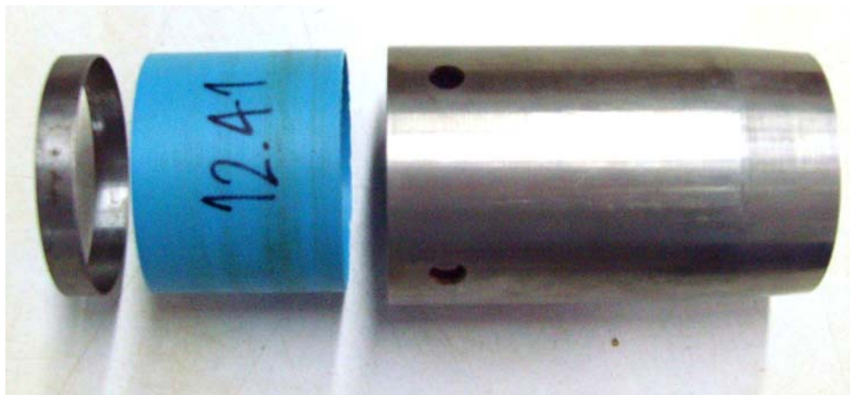
รูปที่ 2.5 กระบอบที่ใช้ในการเก็บตัวอย่างดิน (KU - Miniature Sampler)
