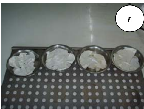
ภาพผนวกที่ 7 ขั้นตอนการวิเคราะห์เปอร์เซ็นต์เนื้อยางแห้งในห้องปฏิบัติการ (อบแห้ง) (ก) ชั่งน้ำหนักน้ำยางสด 10 มิลลิกรัม (ข) เติมกรดฟอร์มิก (2 เปอร์เซ็นต์) 15 มิลลิตร (ค) ยางที่จับตัวเป็นแผ่นบาง (ง) อบยางที่อุณหภูมิ 70 องศาเซลเซียส นาน 24 ชั่วโมง
