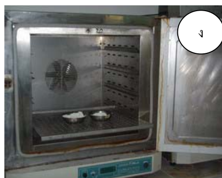
ภาพผนวกที่ 7 ขั้นตอนการวิเคราะห์เปอร์เซ็นต์เนื้อยางแห้งในห้องปฏิบัติการ (อบแห้ง) (ก) ชั่งน้ำหนักน้ำยางสด 10 มิลลิกรัม (ข) เติมกรดฟอร์มิก (2 เปอร์เซ็นต์) 15 มิลลิตร (ค) ยางที่จับตัวเป็นแผ่นบาง (ง) อบยางที่อุณหภูมิ 70 องศาเซลเซียส นาน 24 ชั่วโมง
