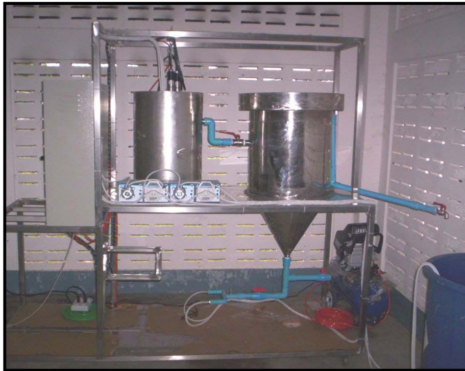
ภาพที่ 2.1 ระบบบำบัดน้ำเสียแบบแอกติเวเตดสลัดจ์จำลองที่ใช้ในห้องปฏิบัติการ ที่มา : วรรณฤดี (2549)
